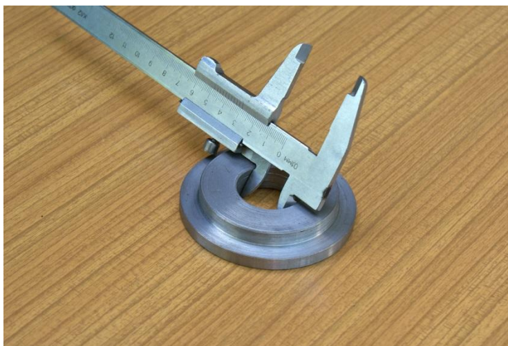
Slika 9. Primjer izravnog mjerenja [10]
