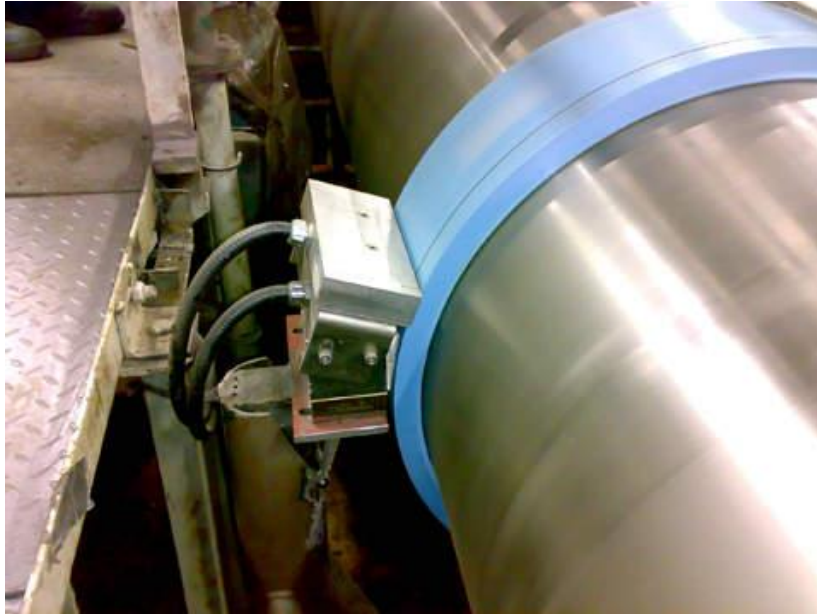
Slika 24. Primjer mjerača momenta na brodskoj osovini [16]
