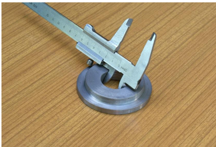
Slika 9. Primjer izravnog mjerenja [10]
