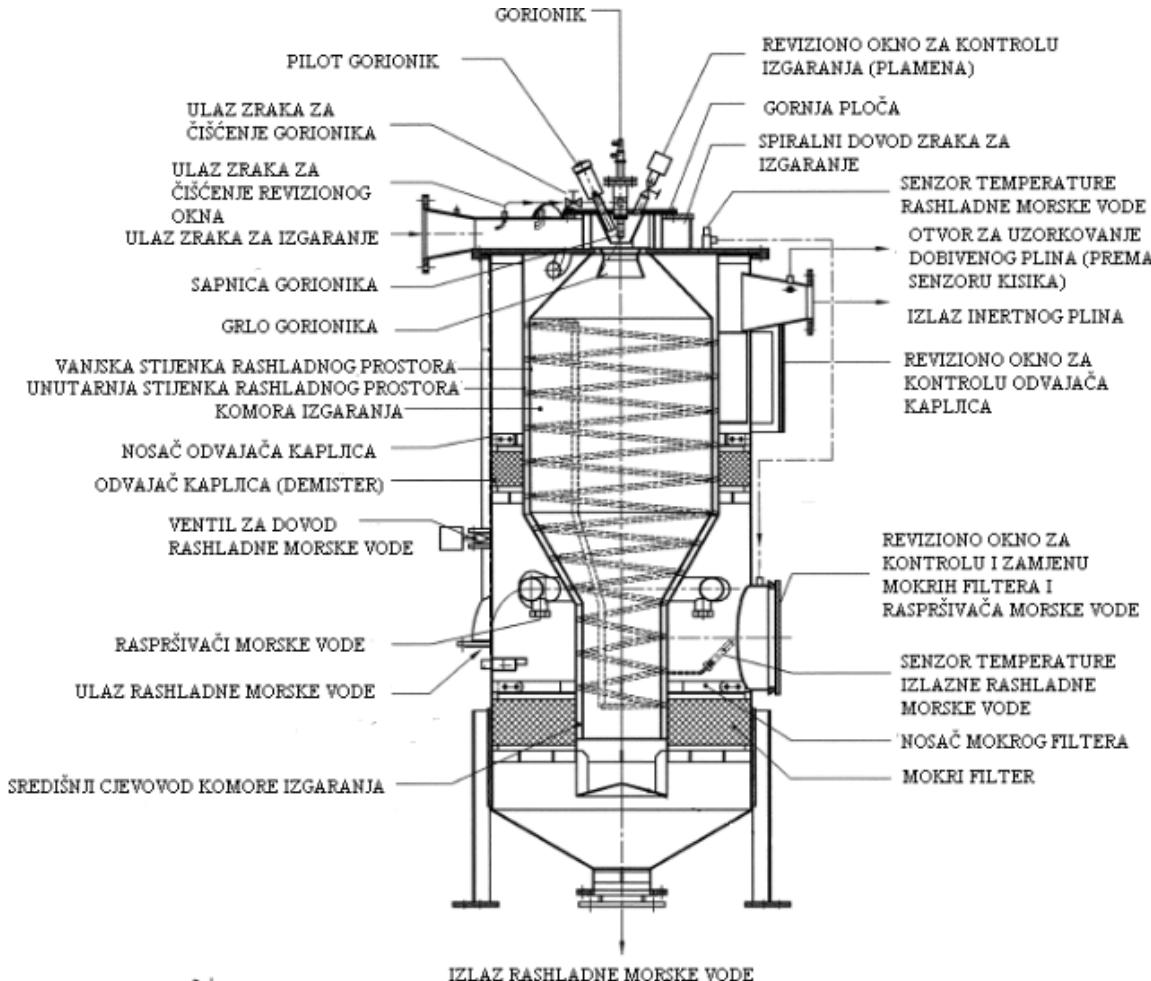
**Slika 9: Poprečni presjek Moss generatora inertnog plina [2]**
