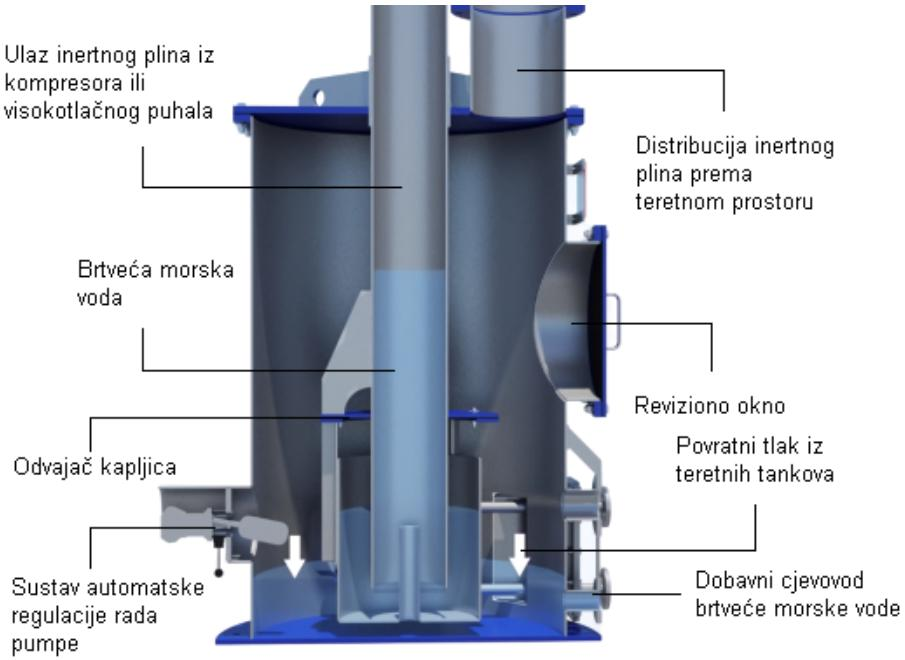
**Slika 6: Poprečni presjek kroz mokru palubnu vodenu brtvu [12]**
