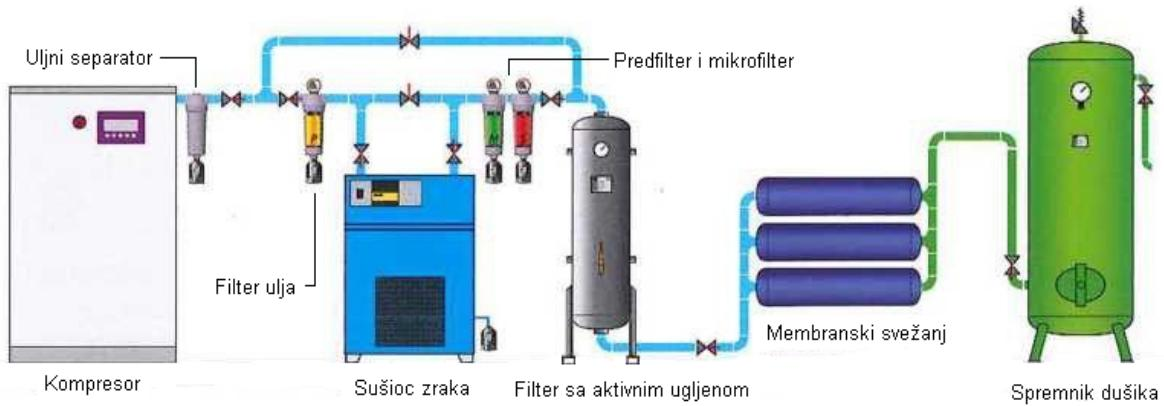
**Slika 4: Shematski prikaz rada generatora dušika [13]**
