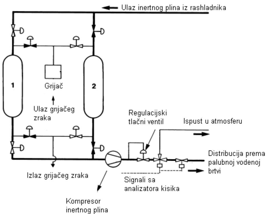
**Slika 7: Shematski prikaz jedinice za sušenje inertnog plina [1]**
