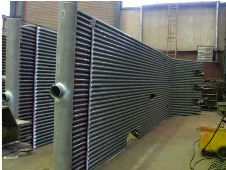
Slika 18. Membranski cijevni zid sa komorom [11]
