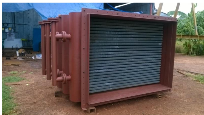
Slika 17. Parni zagrijač zraka [24]
