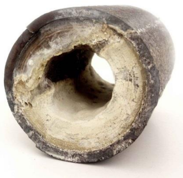
Slika 22. Prikaz istaloženog kamenca u cijevi [23]
