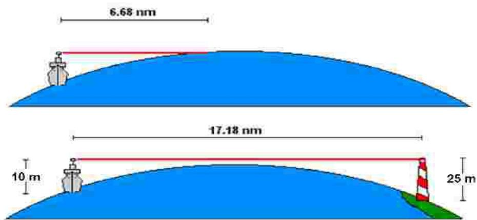
Slika 12.Udaljenost radarskog horizonta[7]
