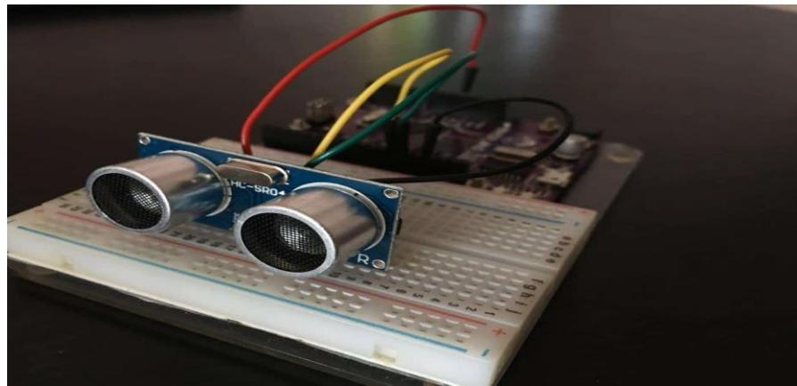
Slika 16. Sklop za ultrazvučno mjerjenje udaljenosti[12]
