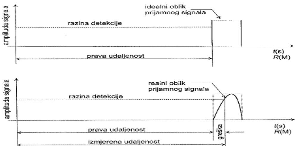
Slika 13. Greška u mjerenuju udaljenosti zbog promjene duljine impulsa[6]
