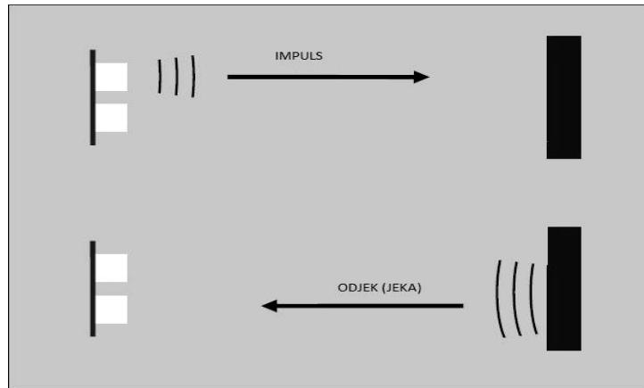
**Slika 15. Princip ultrazvučnog mjerjenja udaljenosti**
