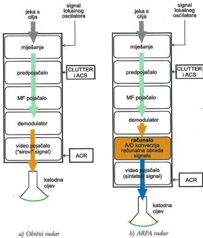
Slika 10.Blok shema običnog i ARPA sustav radara[6]
