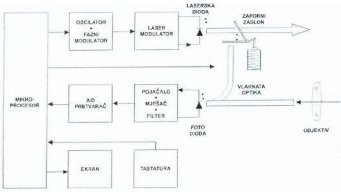
**Slika 7.Blok shema laserskog daljinomjera Leica "DISTO"**
