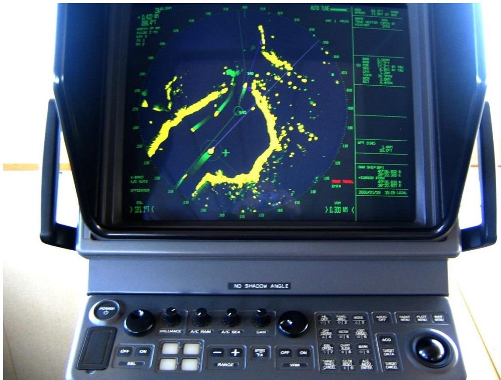
Slika 9. ARPA radarsko ucrtavanje na brodu
