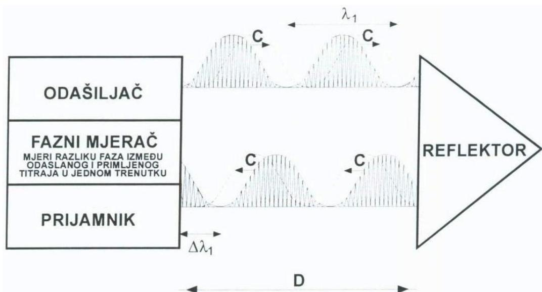
Slika 4. Princip faznog načina mjerena duljina
