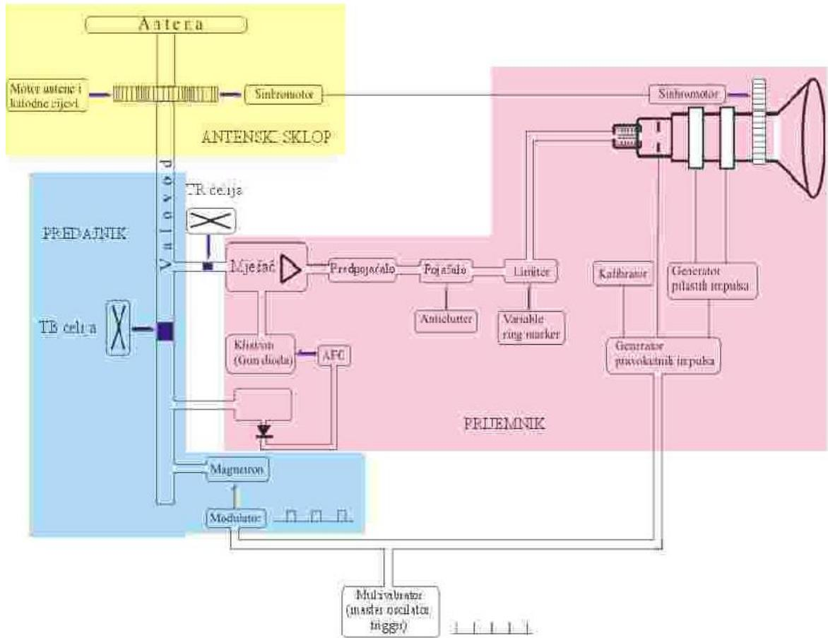
Slika 11.Blok shema brodskog radara
