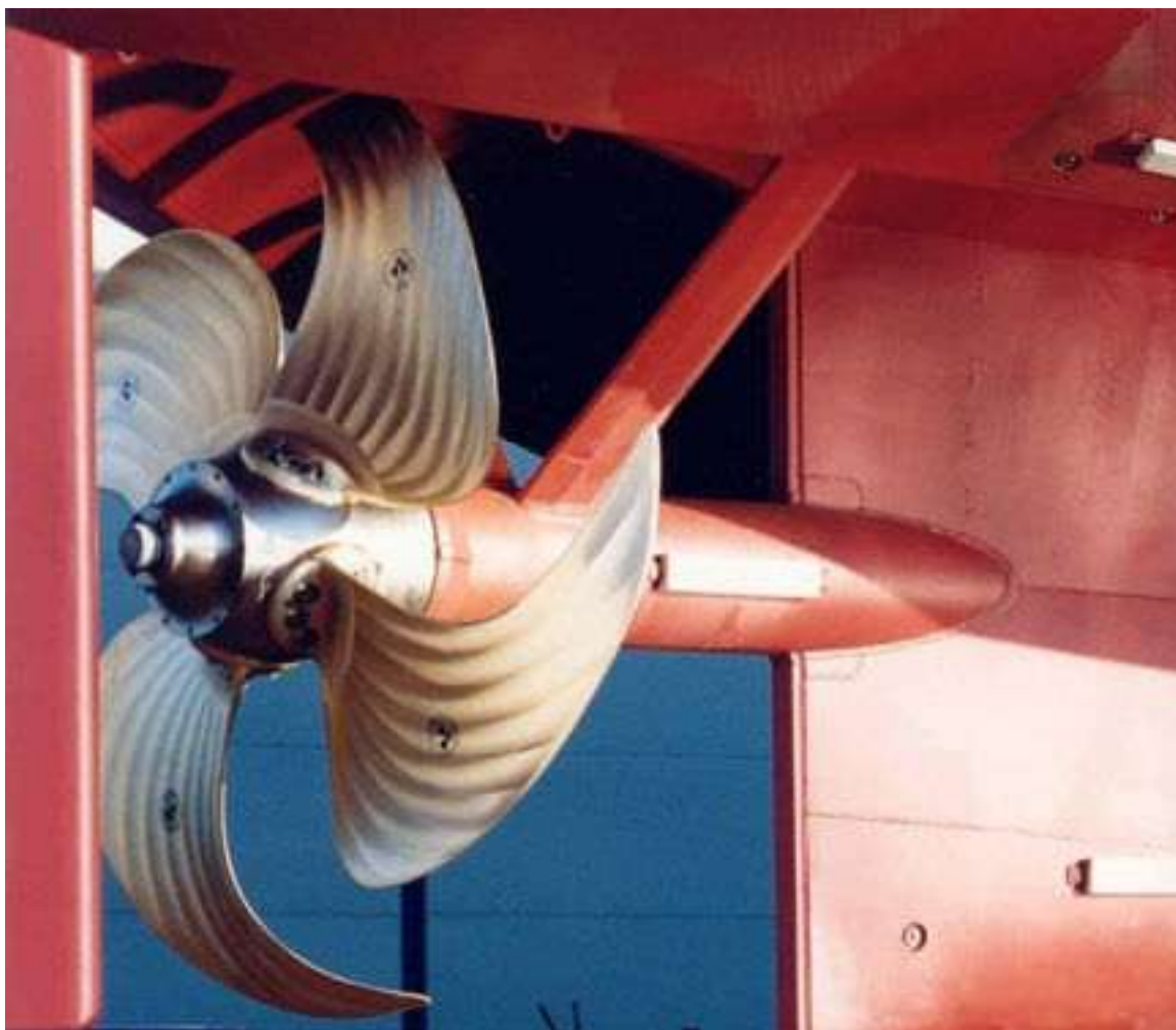
Slika 3. Brodski vijak s promjenjivim usponom krila [5]
