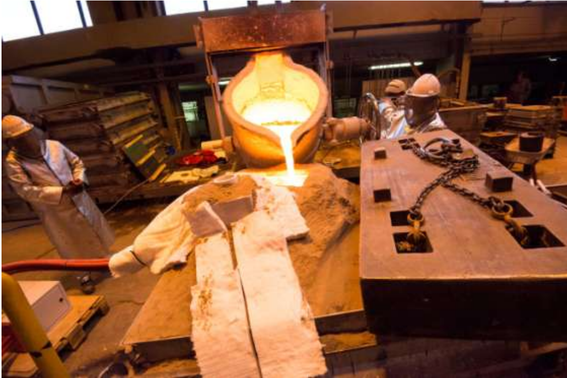
Slika 15. Proces izljevanja legure brodskog vijka u njegov kalup [12]
