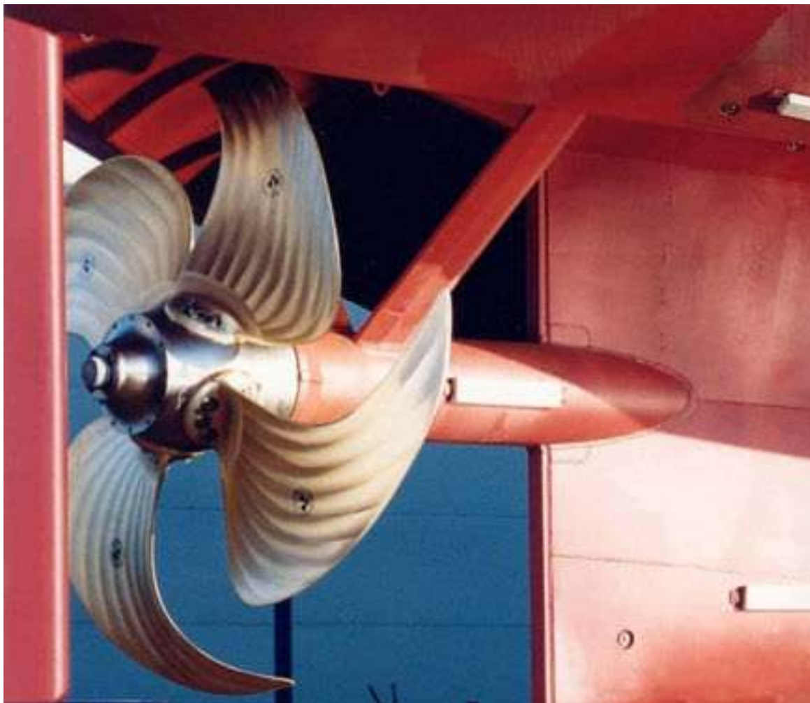
Slika 3. Brodski vijak s promjenjivim usponom krila [5]
