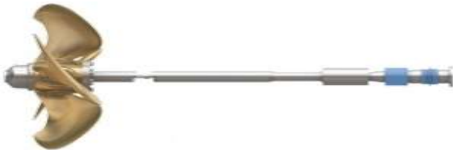
Slika 25. Uređaj za dobavu ulja u osovini [17]
