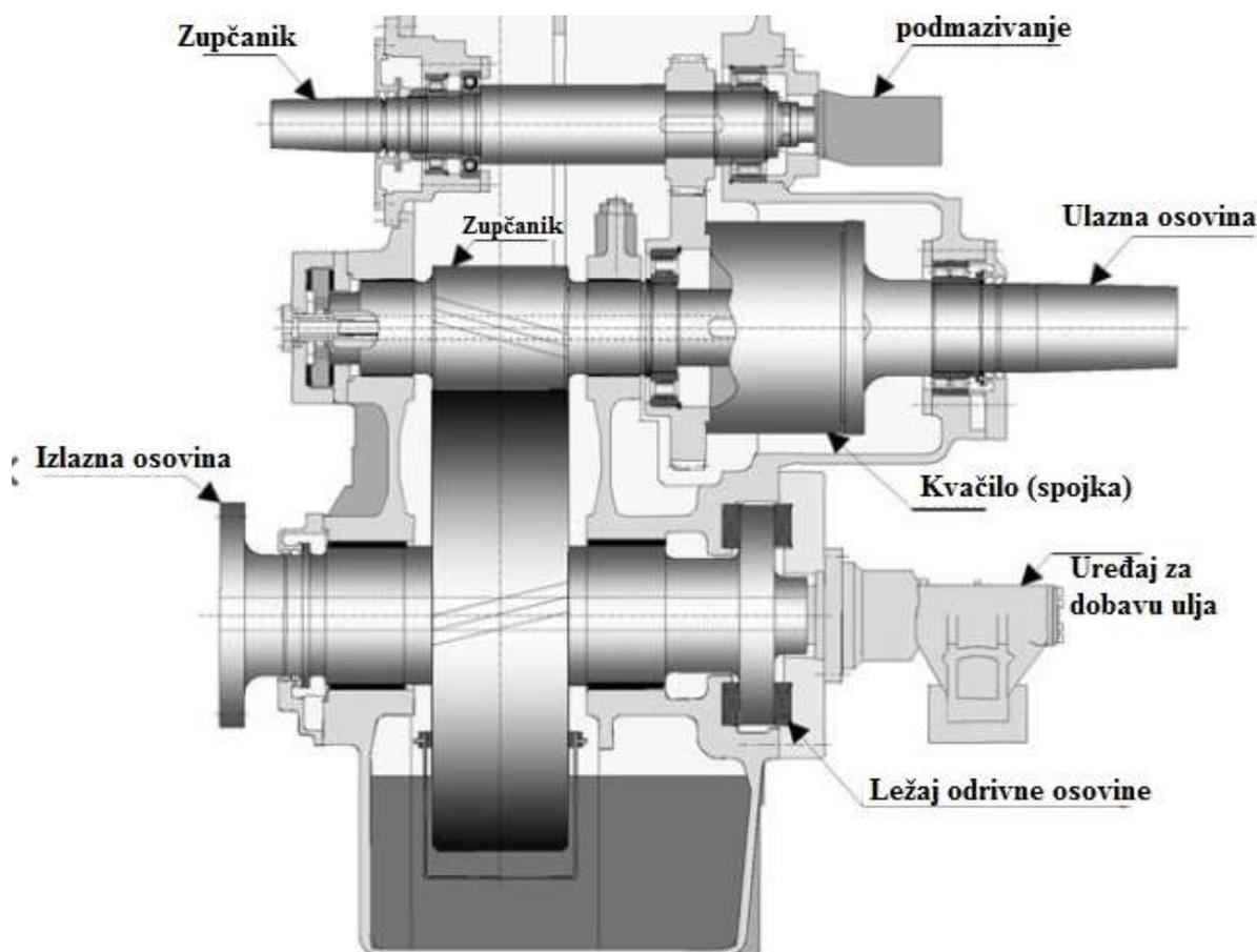
Slika 29. Unutrašnjost jednostupanjskog wartsila reduktora s spojkom [18]
