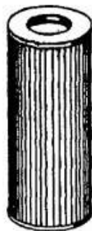
Slika 22. Filter povrata ulja [14]
