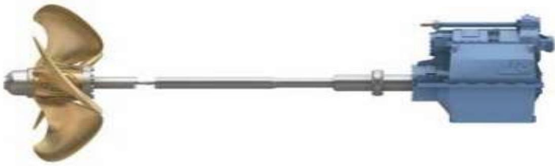
**Slika 27. Uređaj za dobavu ulja integriran u reduktor [17]**
