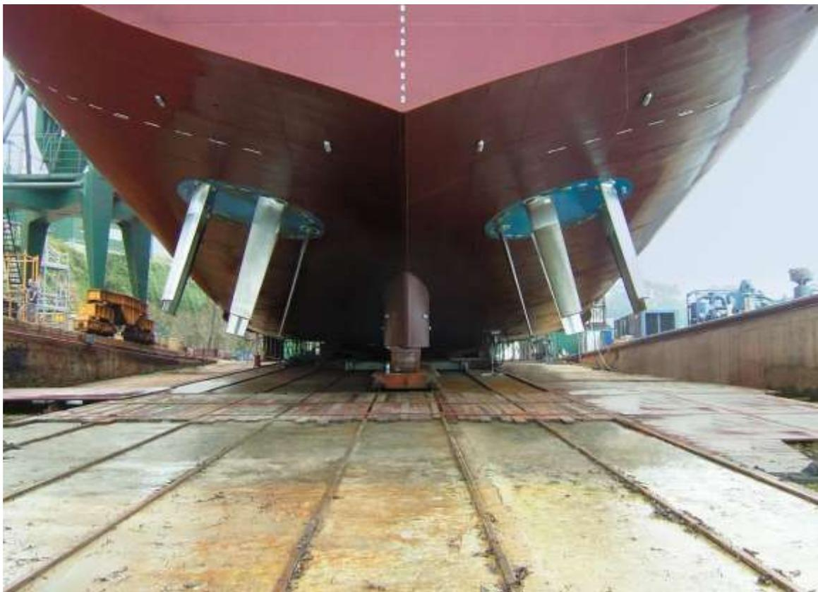
Slika 6. Cikloidni propulzor [7]
