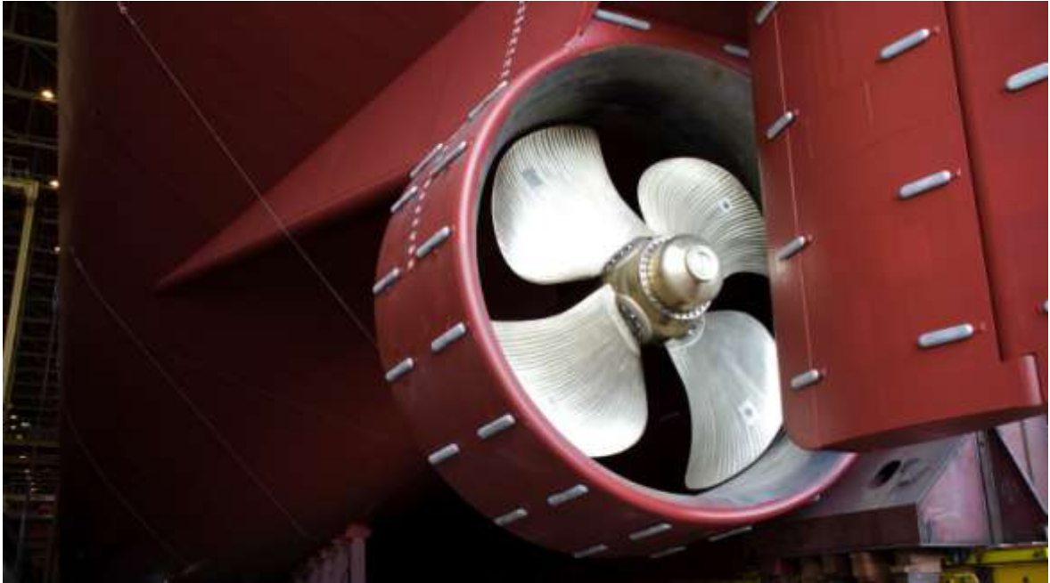
Slika 49. Primjer brodskog CPP vijka s broda ALFA [26]
