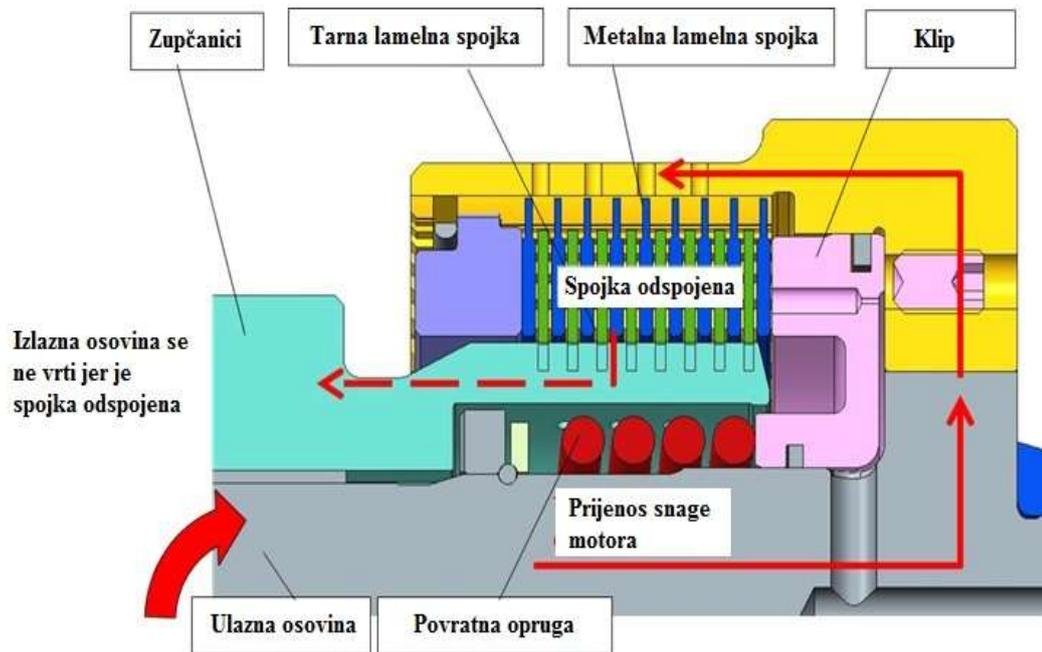
Slika 30. Spojka odspojena [19]
