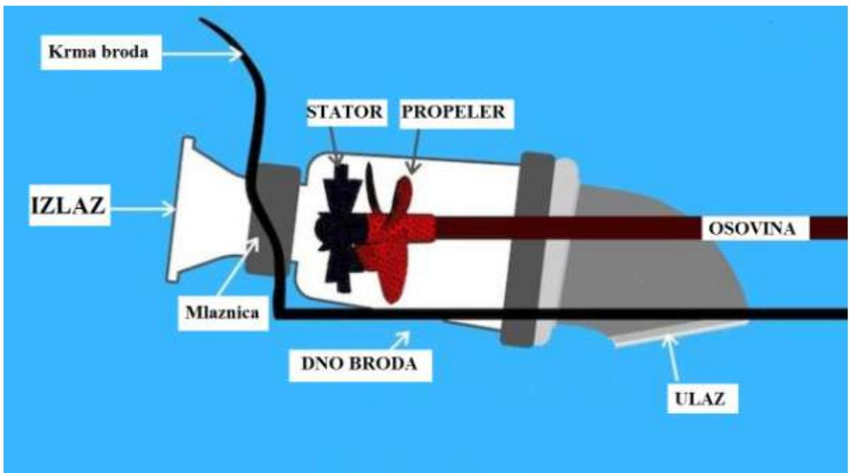
Slika 7. Vodmlazni propulzor s unutarјim dijelovima [8]
