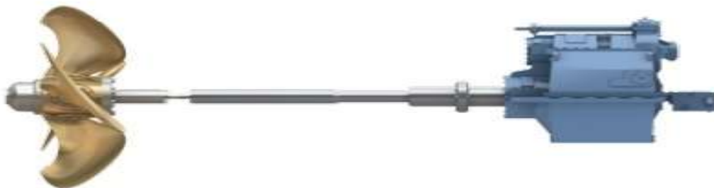
Slika 26. Uređaj za dobavu ulja ispred reduktora [17]
