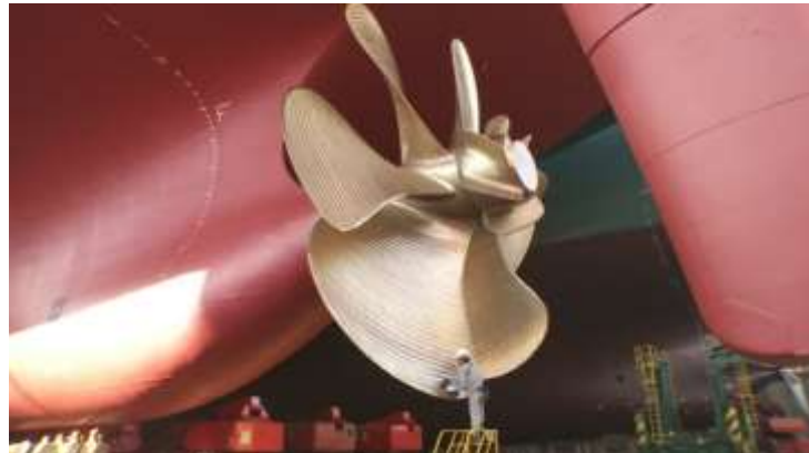
Slika 1. Brodski vijak s fiksnim usponom krila [3]
