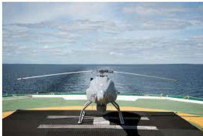
Slika 28. Saab Skeldar V-200 na palubi vojnog broda
