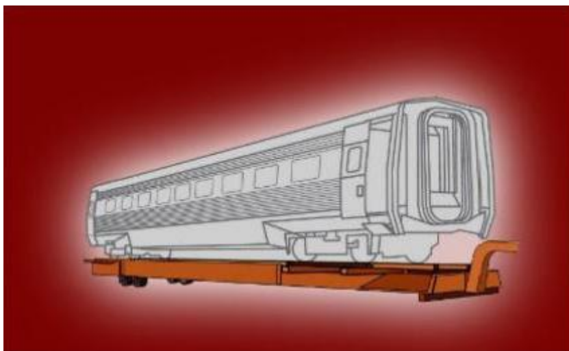
Slika 32. Spuštena ro-ro prikolica [13]
