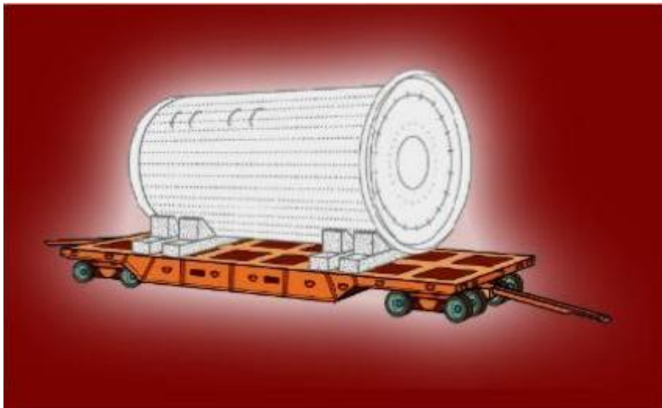
Slika 31. Sklopiva spuštena RO-RO prikolica [13]
