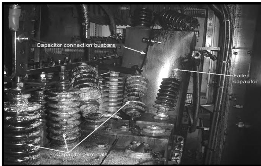
Slika 41. Eksplozirao SN kondenzator na brodu Queen Mary 2 [1]
