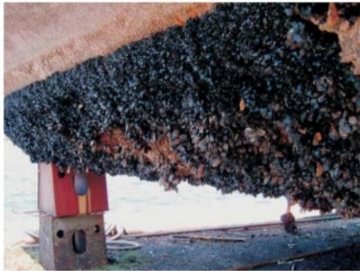
**Slika 16. Obraslo dno plutajuće platforme [6]**
