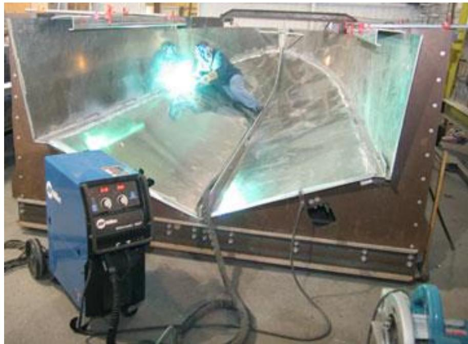
**Slika 27. Zavarivanje trupa broda MIG postupkom (deblji limovi)**
