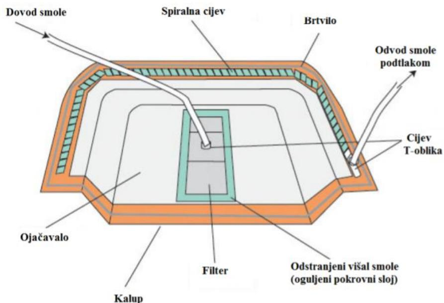
Slika 70. Postupak podtlačnog ulijevanja s jednostavnim kalupom [30]
