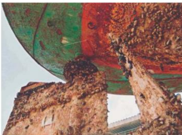
Slika 15. Obraštanje podvodnog dijela broskog trupa [6]
