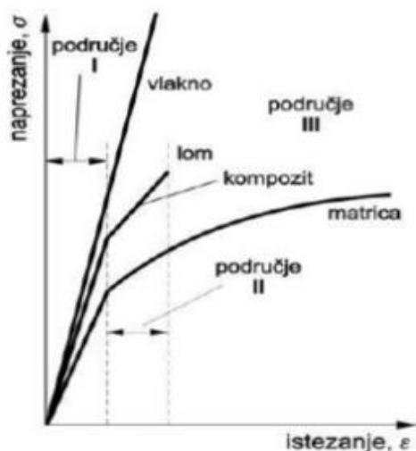
Dijagram 6. "naprezanje-istezanje" vlaknima ojačanog kompozita [16]
