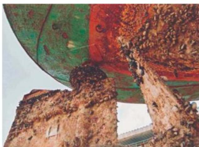
**Slika 15. Obraštaj podvodnog dijela brodskog trupa [6]**
