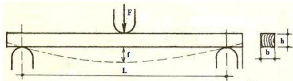
**Slika 35. Prikaz općeg postupka određivanja modula elastičnosti [3]**
