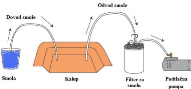
**Slika 69. Pojednostavljeni prikaz postupka podtlacičnog ulijevanja [30]**
