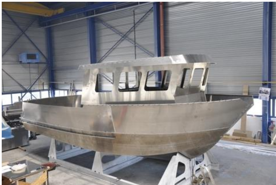
Slika 20. Zavareni aluminijski trup s nadgrađem
