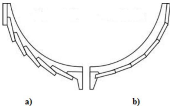
**Slika 45. Usporedba klinker (a) i karvel (b) tipa gradnje [3]**
