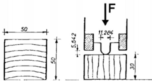
Slika 36. Prikaz metode određivanja tvrdoće drva [3]
