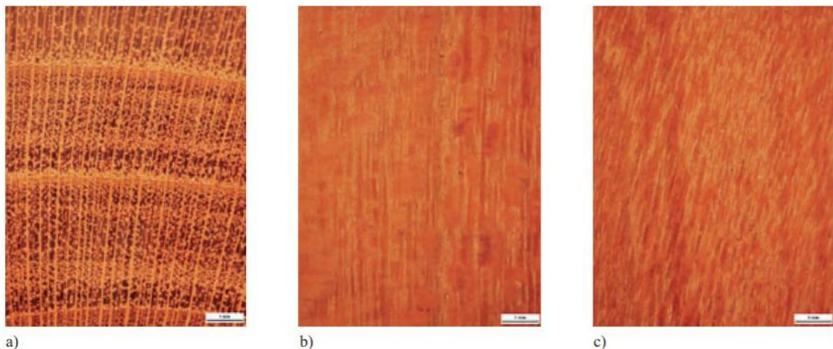
**Slika 34. Primjer vrste drva: a) poprečni presjek, b) radijalni presjek, c) tangecijalni presjek [30]**
