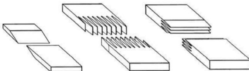
Slika 41. Prikaz lamenarnih spojeva [3]
