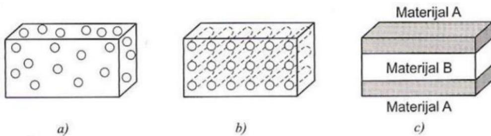
**Slika 51. Usporedba osnovnih tipova kompozita: (a) kompoziti s česticama, (b) kompoziti s vlknima, (c) slojeviti kompoziti [20]**
