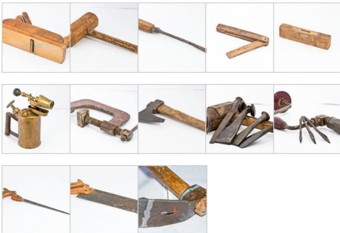
Slika 46. Osnovni tradicionalni alati za drvenu brodogradnju
