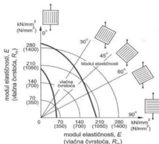
**Slika 55. Utjecaj usmjerjenja vlakana obzirom na naprezanje na kao primjer Ti-leguru ojačanu vlaknima bora [16]**
