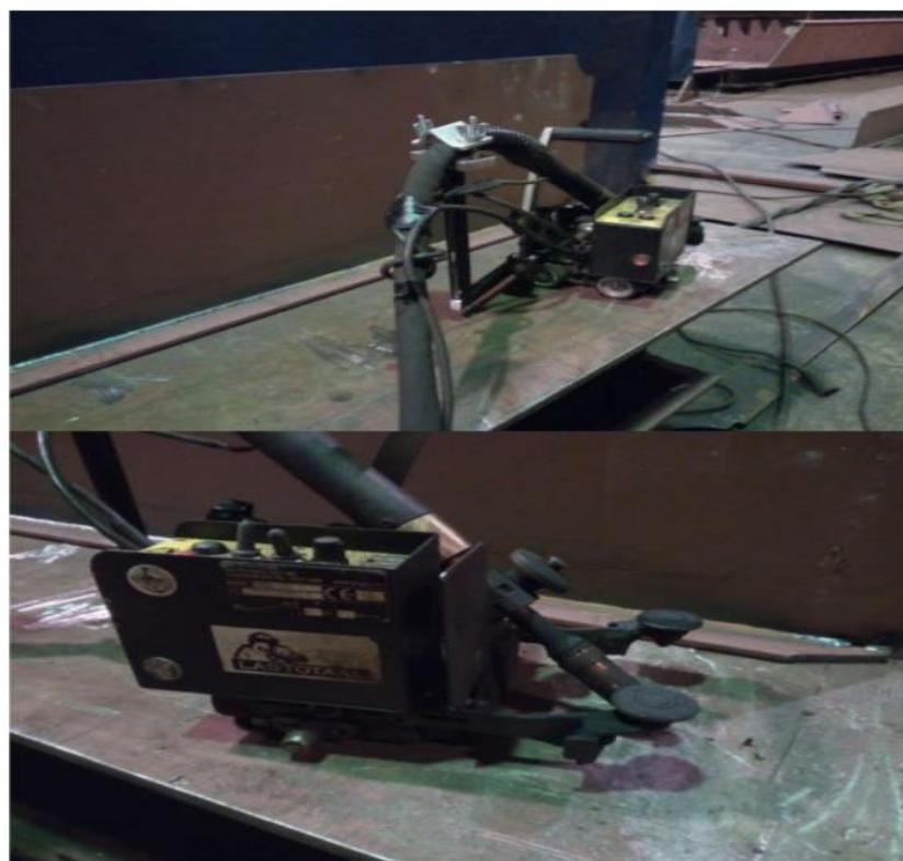
**Slika 11. Zavarivanje pomoću automastkog MIG aparata za zavarivanje kojim se pojednostavljuje postupak zavarivanja dugih ravnih profila [14]**
