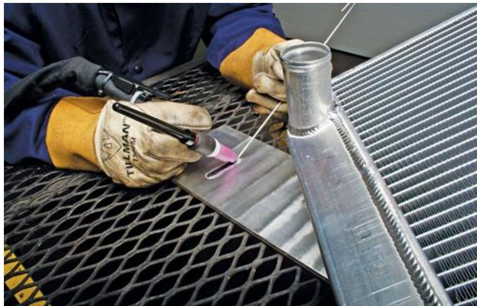
**Slika 26. Postupak zavarivanja TIG postupkom (tanki limovi)**
