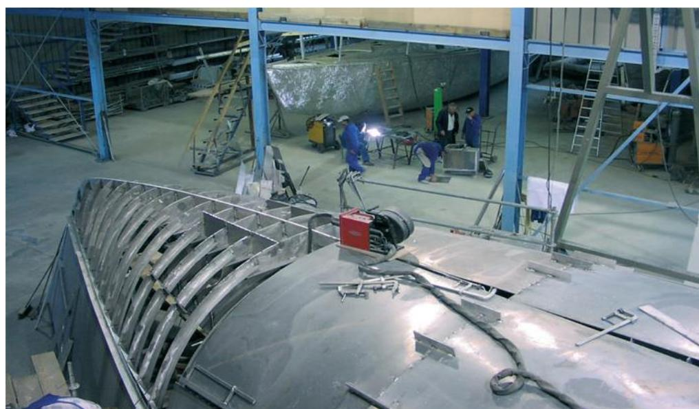
**Slika 25. Proces zavarivanja aluminija u zatvorenom prostoru [39]**
