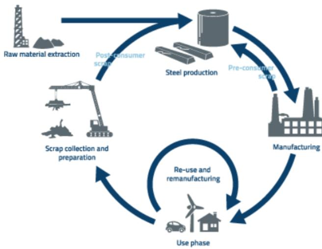
Slika 17. Proces recikliranja čelika [33]
