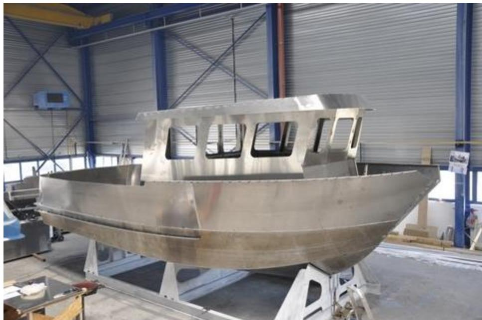
**Slika 20. Zavareni aluminijski trup s nadgradjem**
