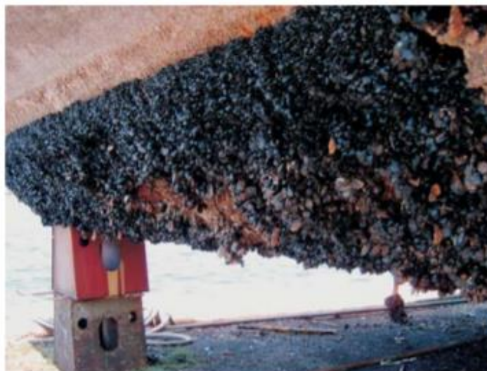
Slika 16. Obraslo dno plutajuće platforme [6]
