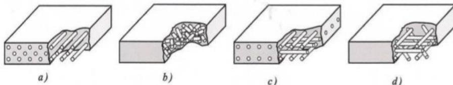
**Slika 53. Različiti načini rasporeda vlaknastih ojačavala (a) kontinuirana jednosmjerna vlakna, (b) slučajno usmjerena diskontinuirana vlakna, (c) ortogonalno raspoređena vlakna, (d) višesmjerno usmjerena vlakna [13]**
