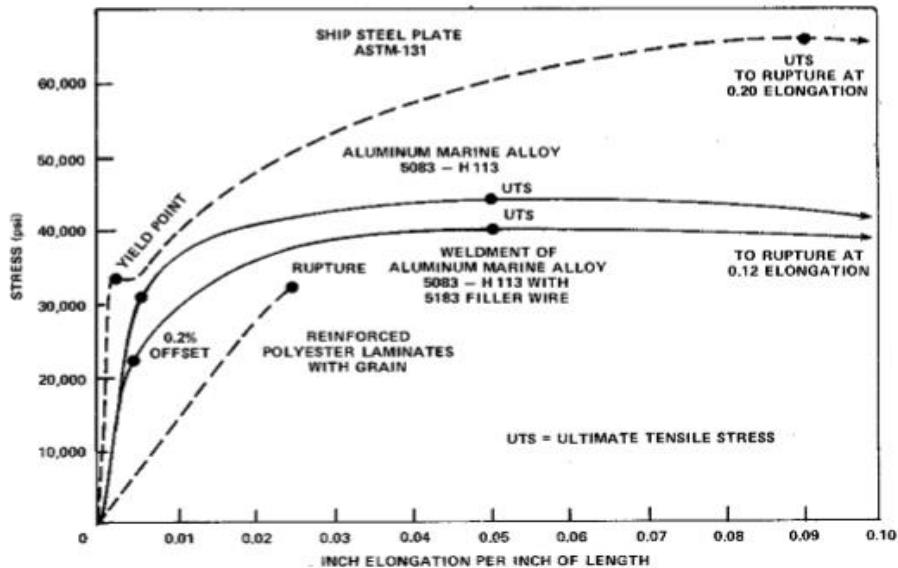
Slika 24. Krivulja naprezanja – deformacije za Aluminijsku slitinu 5083 [37]
