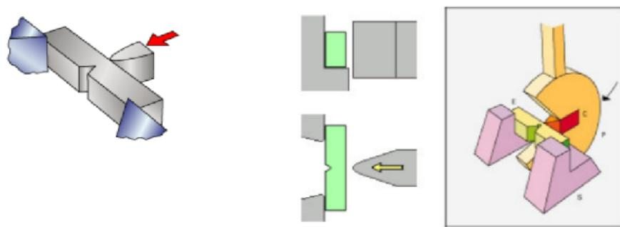
**Slika 1. Ispitivanje udarne radnje loma [34]**
