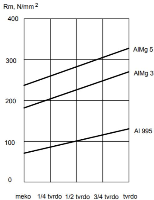
**Slika 21. Hladnom deformacijom povećava se čvrstoća [37]**
