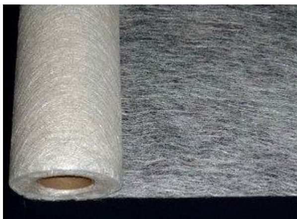
Slika 60. Stakleni mat 400 g/m 2 [30]
