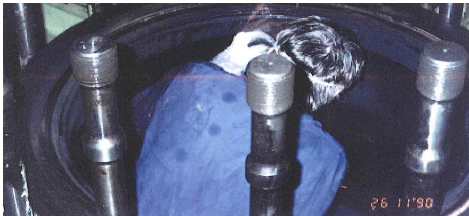
Slika 35. Nepravilan način brušenja istrošenog ruba košuljice [7]
