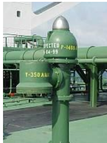
Slika 10. Leptir ventil (lijevo) i 11P/V ventil (desno)
