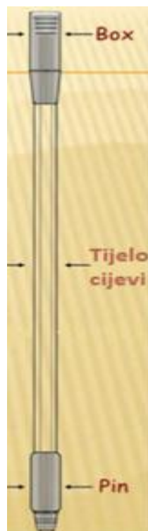
Slika 39. Karakteristične značajke cijevi za bušenje [26]
