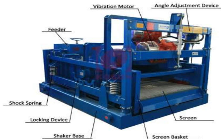
Slika 52. Uređaj za kontrolu krutih tvari [13]
