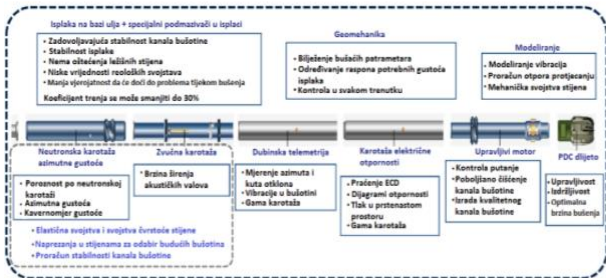
Slika 55. Sklop za usmjereno bušenje s osnovnim komponentama [5]
