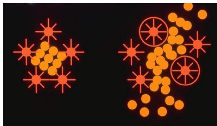
**Slika 3. Promjena kristalne strukture voska uslijed korištenja aditiva [5]**
