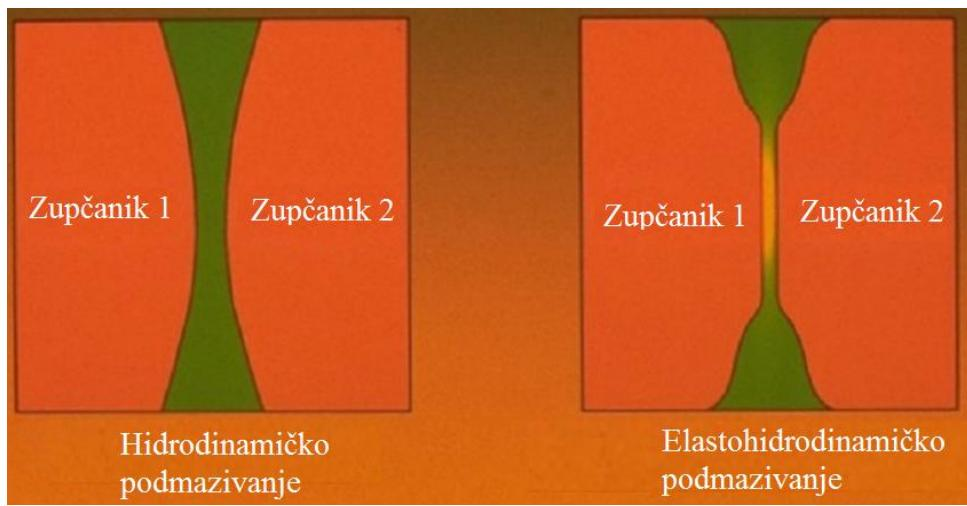
**Slika 14. Prikaz hidrodinamičkog i elastohidrodinamičkog podmazivanja [5]**
