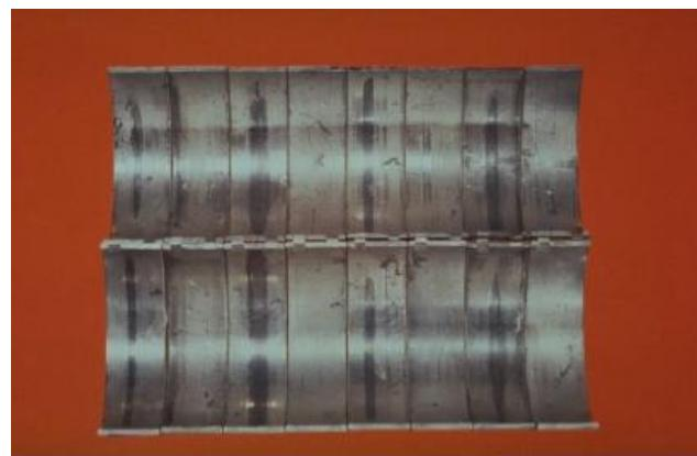
**Slika 27. Adhezijsko trošenje zbog niske dobave ulja [6]**
