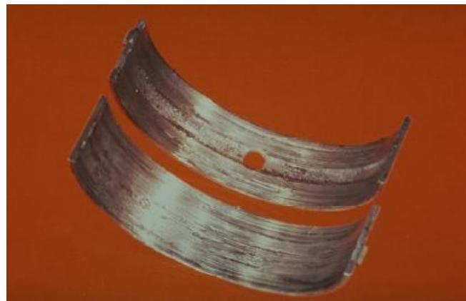
**Slika 29. Adhezijsko trošenje do aluminijskog sloja [6]**
