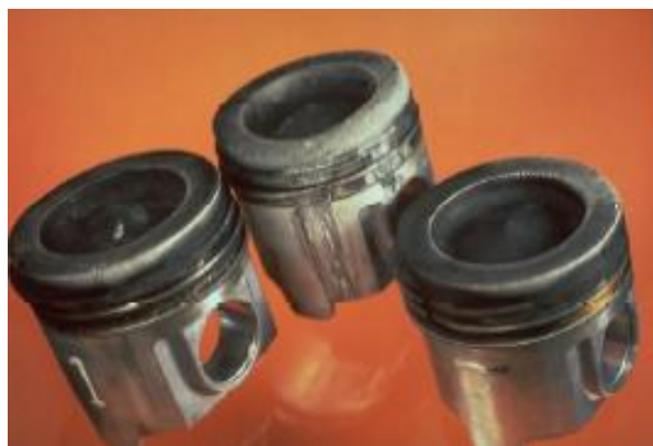
Slika 20. Prikaz erozije glave klipa koja rezultira zaribavanjem [7]
