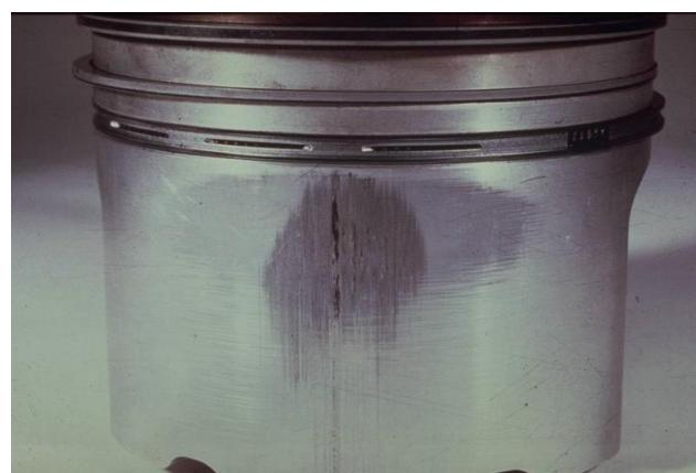
**Slika 21. Adhezijsko trošenje kod hladnog starta [7]**
