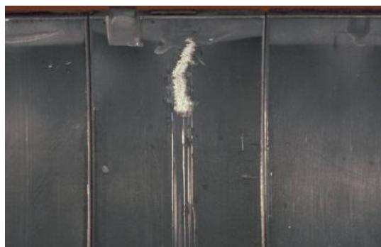
**Slika 34. Oštećenje uzrokovano kavitacijskom erozijom [6]**
