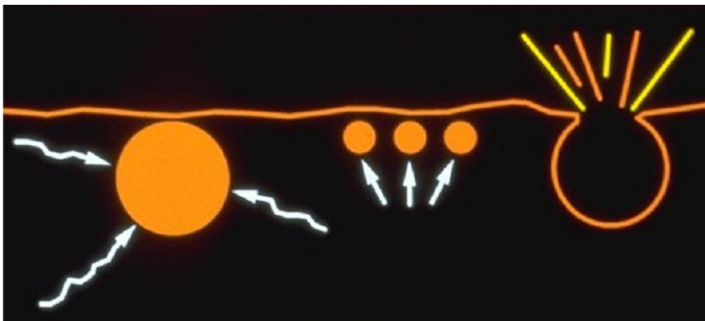
Slika 4. Aditivi protiv pjenjenja kao silicijsko ulje [5]
