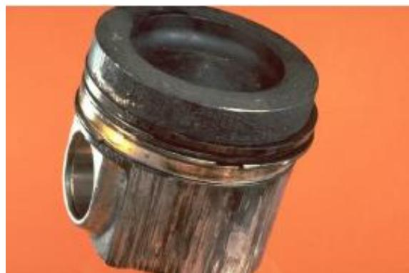
**Slika 22. Trošenje prstenova zbog loše kvalitete ulja [7]**
