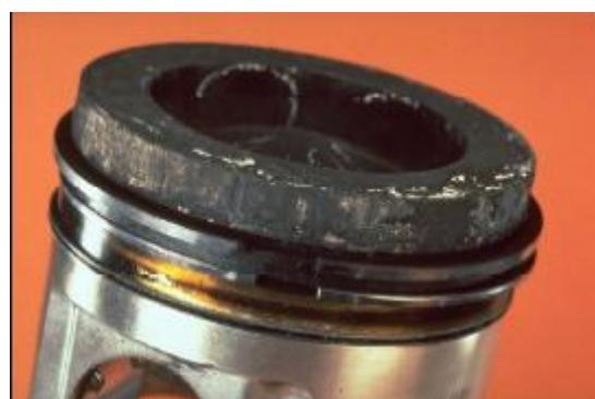
**Slika 25. Abrazivno trošenje zbog naslaga ugljika na vrhu klipa [7]**
