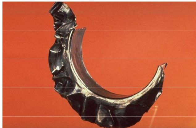
**Slika 30. Puknuće čeličnog kućišta ležaja zbog nedostatka podmazivanja [6]**
