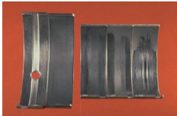
**Slika 28. Adhezijsko trošenje zbog loše kvalitete ulja za podmazivanje [6]**
