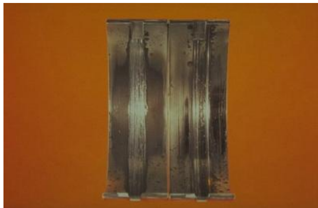
Slika 31. Abrazivno istrošenje uzrokovano tvrdim česticama [6]
