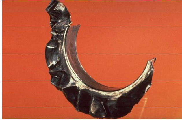
Slika 30. Puknuće čeličnog kućišta ležaja zbog nedostatka podmazivanja [6]
