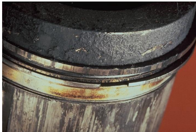
Slika 23. Prikaz zamazane površine klipa i prstenova koji ukazuje na problem s uljem [7]
