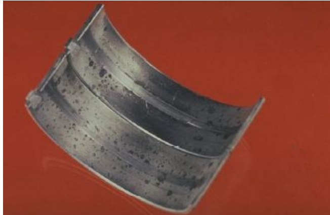
Slika 32. Tipično abrazivno oštećenje [6]
