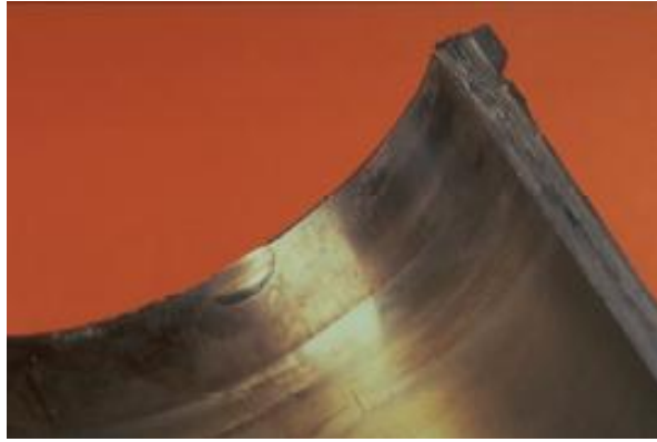
Slika 26. Tipični znakovi rupičaste korozije [7]
