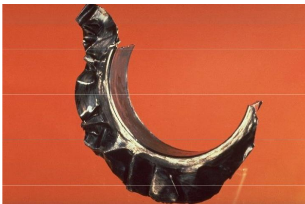
Slika 30. Puknuće čeličnog kućišta ležaja zbog nedostatka podmazivanja [6]
