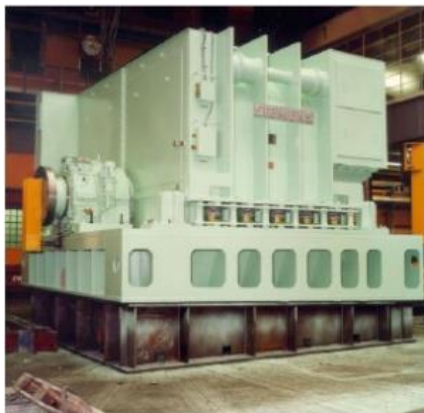
Slika 6: Izmjenični propulzijski motor [8]
