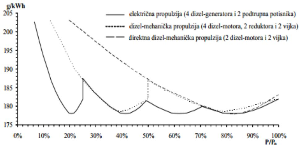
**Slika 2: Usporedba specifične potrošnje goriva u zavisnosti od ukupne razvijene snage na osovinama dizelskih motora [2]**
