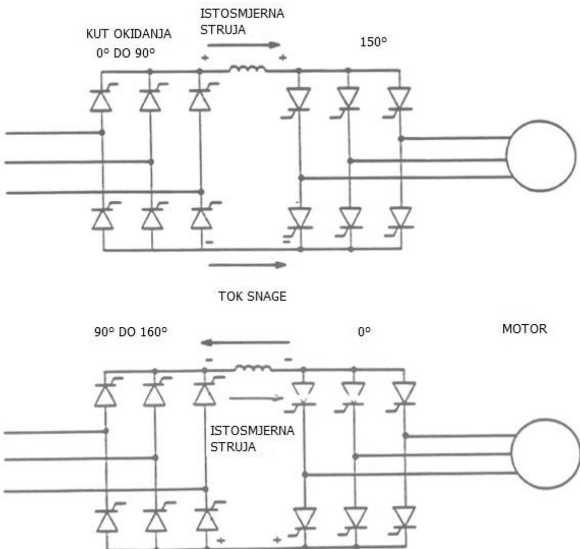
Slika 5:Tok električne struje kod propulzije i regeneracije[1]
