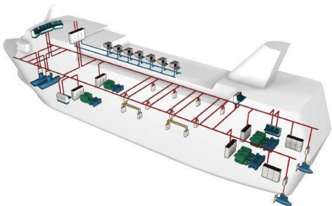
**Slika 12. Sustav električne propulzije s podtrupnim potisnicima – Azipod [10]**
