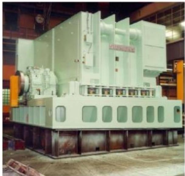
**Slika 6: Izmjenični propulzijski motor [8]**
