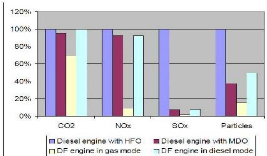
**Slika 9: Usporedba emisija ispušnih plinova između dizelskog i dual fuel motora [9]**
