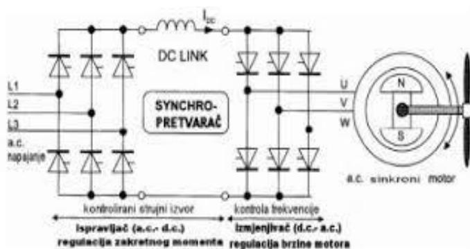
**Slika 3. Sinkrokonverter [1]**
