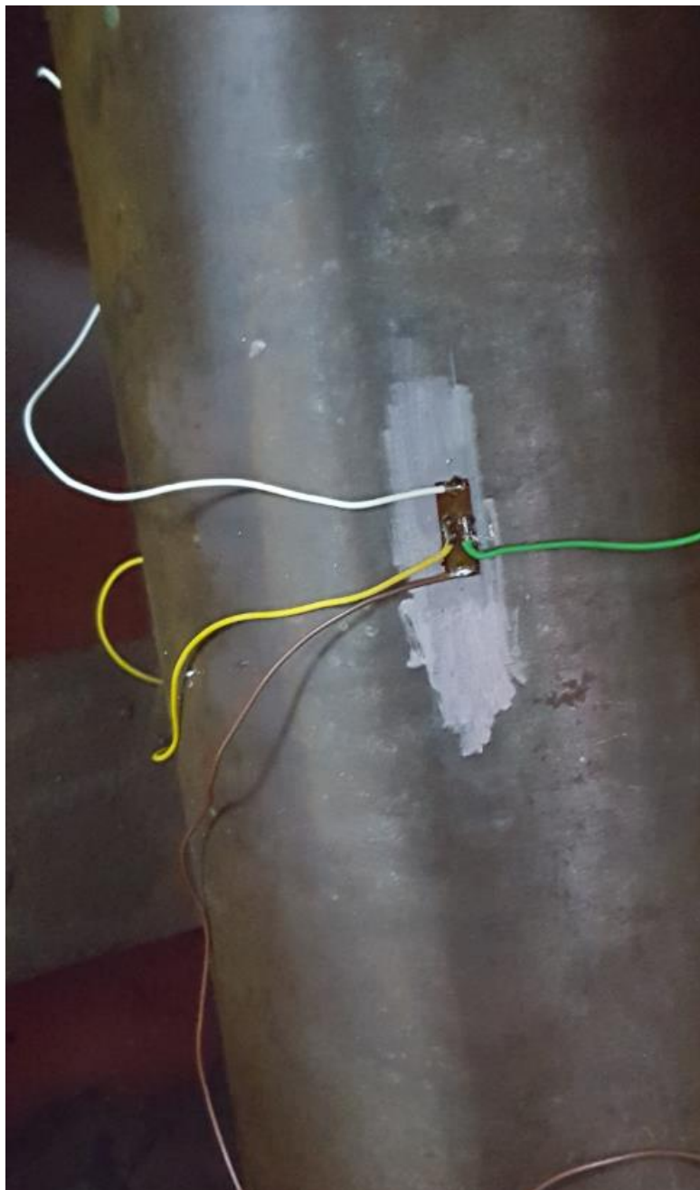
Slika 20. Izgled tenzometarskih traka nakon zalemljenih žica [izvor Luka Bugarin]
