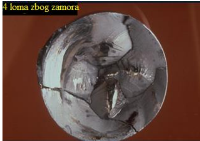
Slika 53. Lom zbog zamora uslijed torzije [20]
