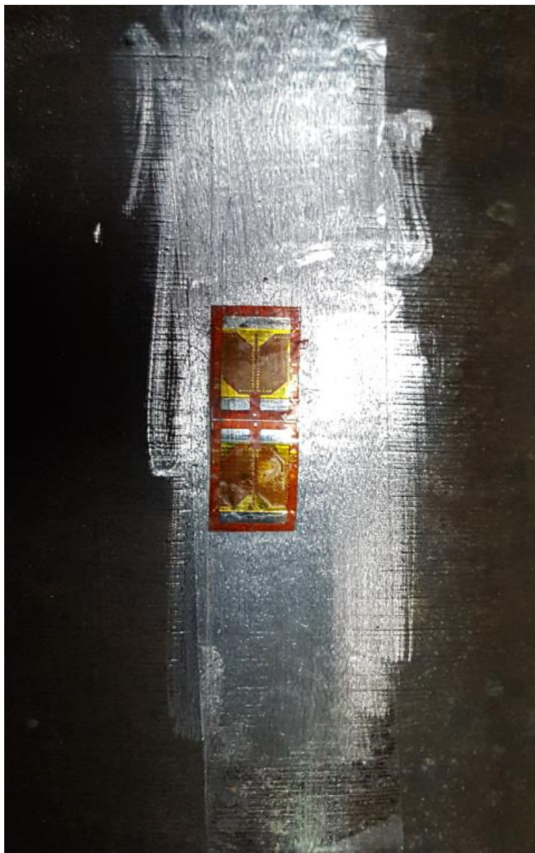
Slika 19. Prikaz međusobno spojenih tenzometarskih traka te nalijepljeni na dio očišćenog vratilnog voda [izvor Luka Bugarin]
