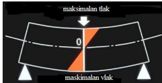
Slika 48. Shema opterećenja na savijanje [20]
