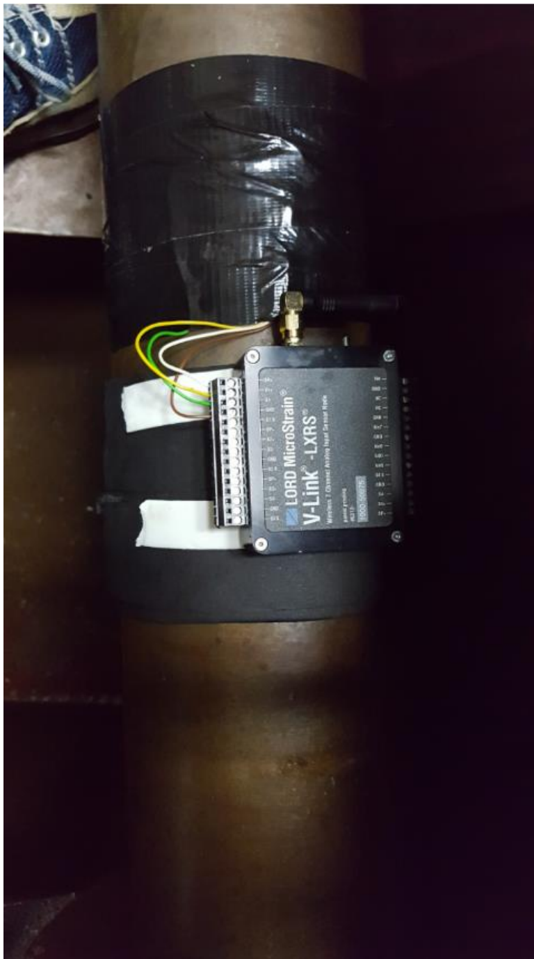
Slika 23. Prikaz odgovarajućeg spajanja žica u senzor [izvor Luka Bugarin]
