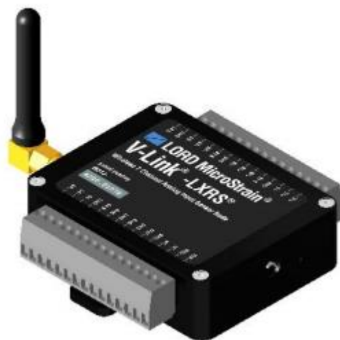
Slika 34. V-Link-LXRS bežični senzorski uređaj [11]
