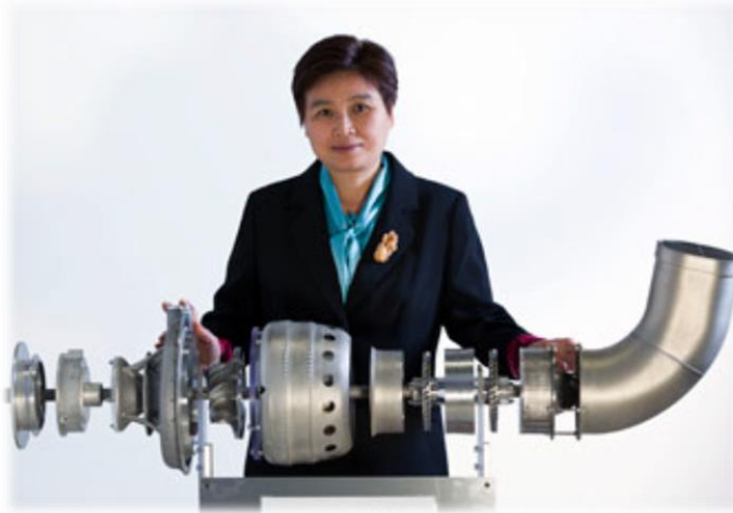
Slika 30. Mlazni motor izrađen 3D tehnologijom tiska [4]
