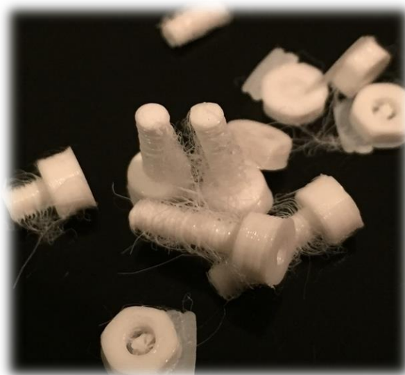
Slika 53. Trošak neuspjeha izrade vijka
