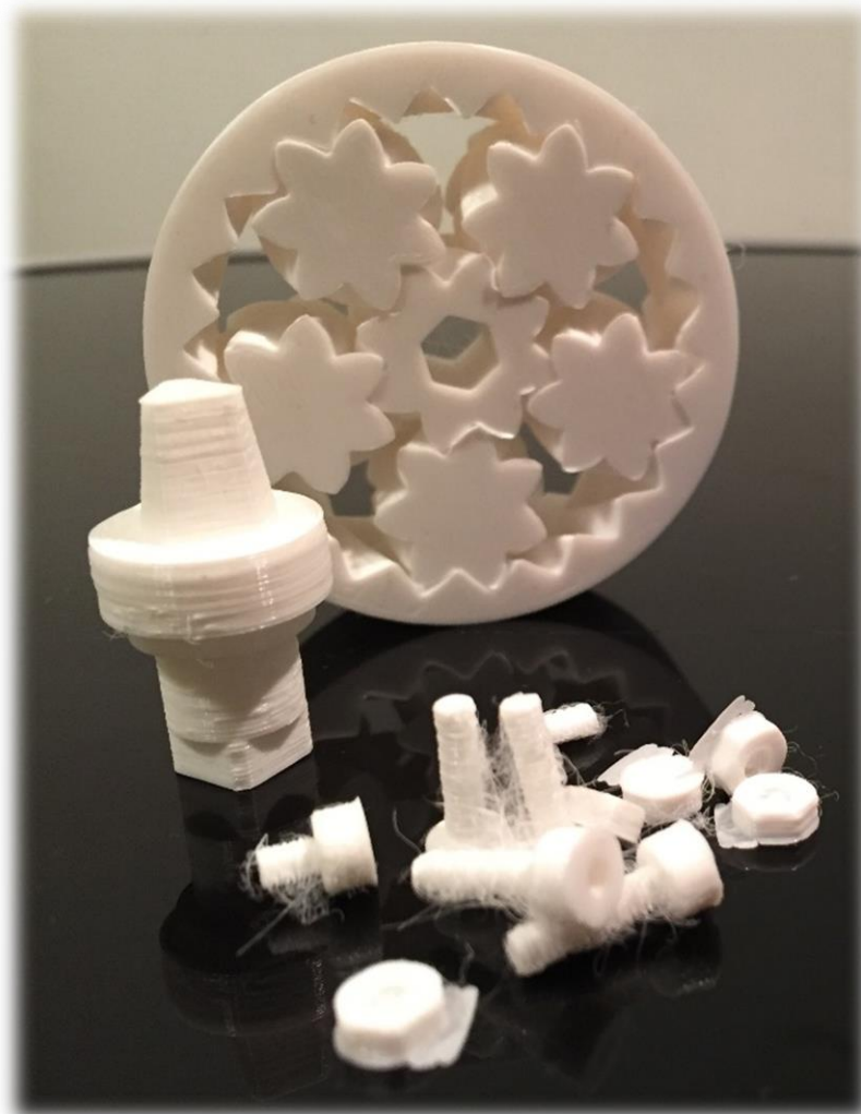
Slika 46. Modeli tiskani FDM tehnologijom 3D tiska
