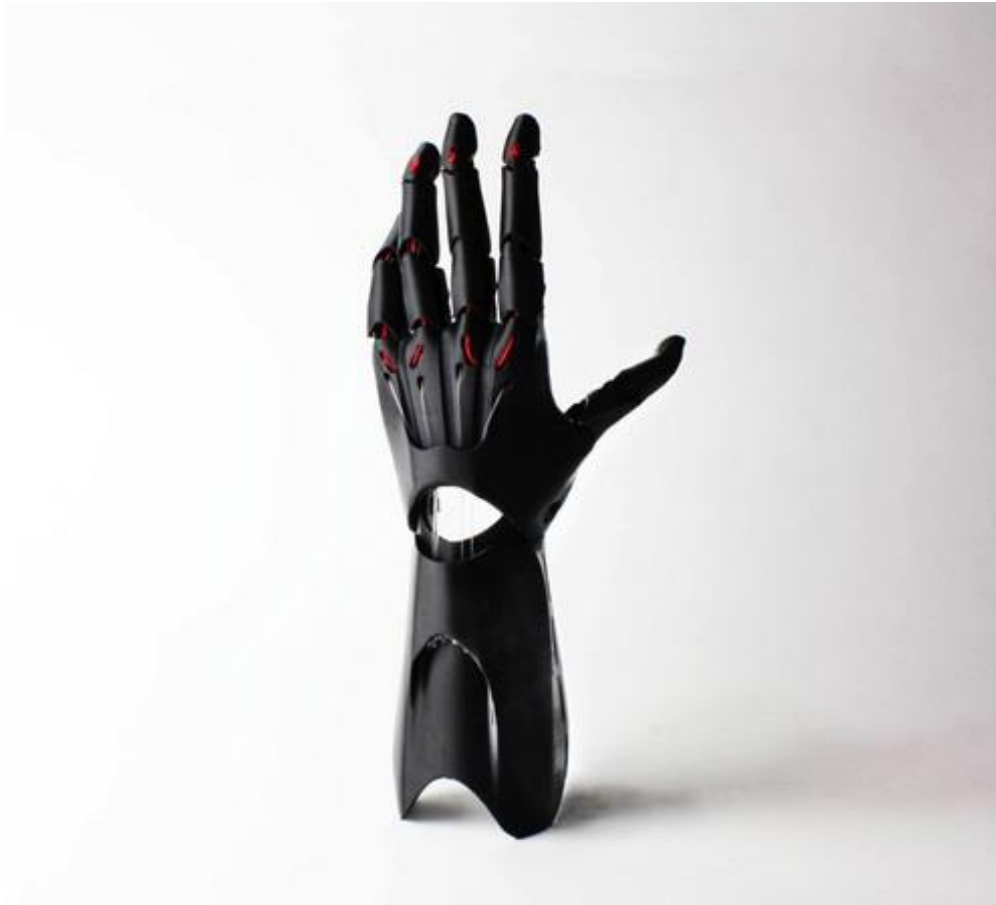
Slika 5. 3D tisak ruke prilagođene krajnjem korisniku (e-NABLE) [10]
