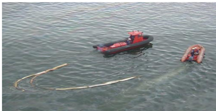
Slika 12. Postavljanje upijača na otvorenom moru [21]
