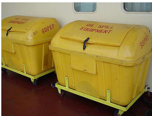
Slika 5. SOPEP oprema na brodu [18]
