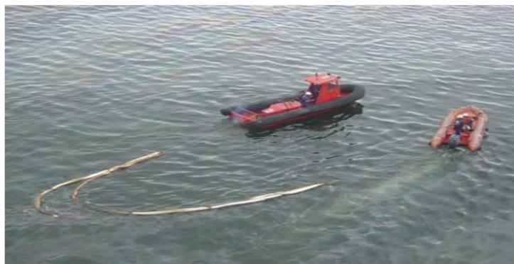
Slika 12. Postavljanje upijača na otvorenom moru [21]
