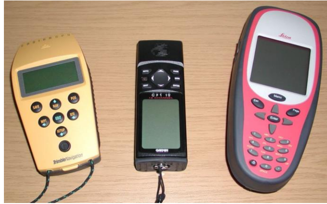
Slika 16. GPS prijamnici dolaze u raznim oblicima od uređaja integriranih u automobile, telefone i satove do posebnih uređaja poput ovih prikazanih ovdje čiji su proizvođači Trimble, Garmin i Leica Izvor: [9]
