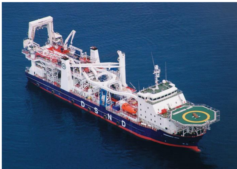
Slika 30. Brod za polaganje cjevovoda Kommandor 3000 , Brodogradilište Viktor Lenac, preinačen 1999. Izvor: [8]
