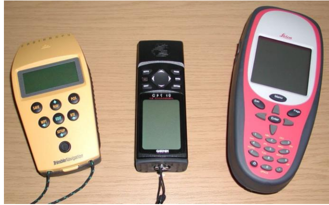
Slika 16. GPS prijamnici dolaze u raznim oblicima od uređaja integriranih u automobile, telefone i satove do posebnih uređaja poput ovih prikazanih ovdje čiji su proizvođači Trimble, Garmin i Leica Izvor: [9]
