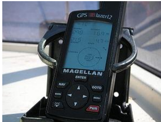
Slika 11. Pokretni GPS radioprijamnik u pomorskoj primjeni Izvor: [9]
