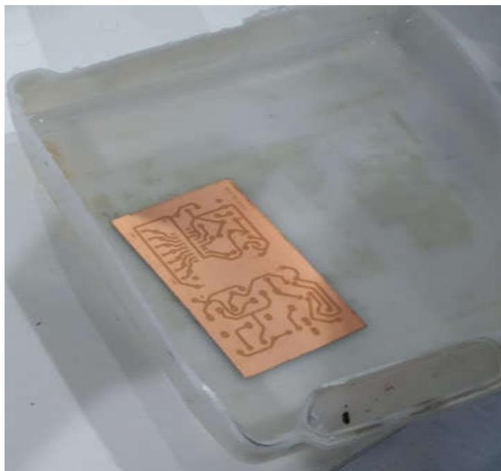
**Slika 28. Razvijanje pločice**
