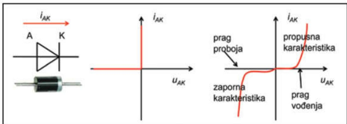
Slika 14. . Simbol diode (lijevo), idealna karakteristika diode (u sredini) i stvarna karakteristika diode (desno) [34]
