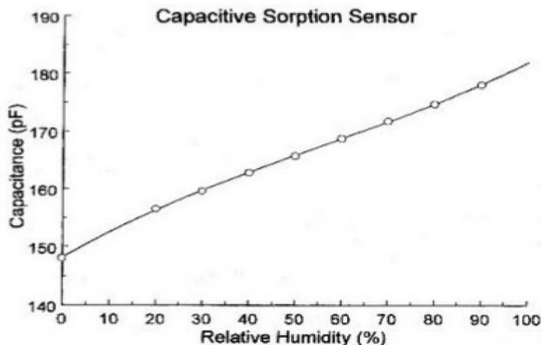
Slika 8. Kapacitet kondenzatora s obzirom na relativnu vlažnost [16].
