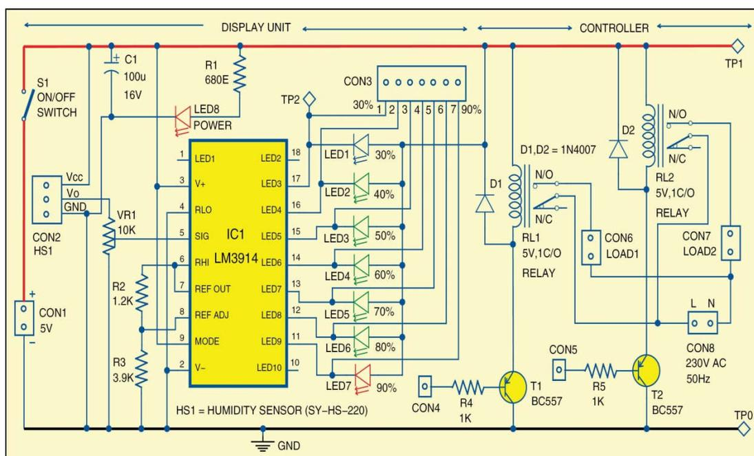
Slika 24. Shema načina rada sklopa za mjerenje vlažnosti[22]
