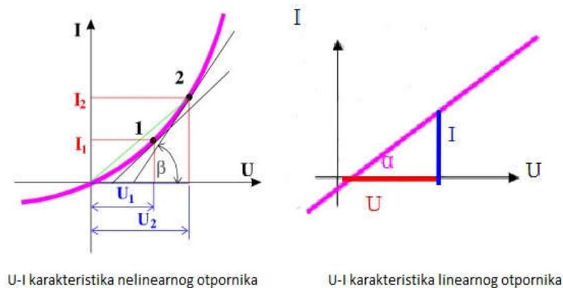
**Slika 18. U-I karakteristike nelinearnog i linearnog otpornika [26]**
