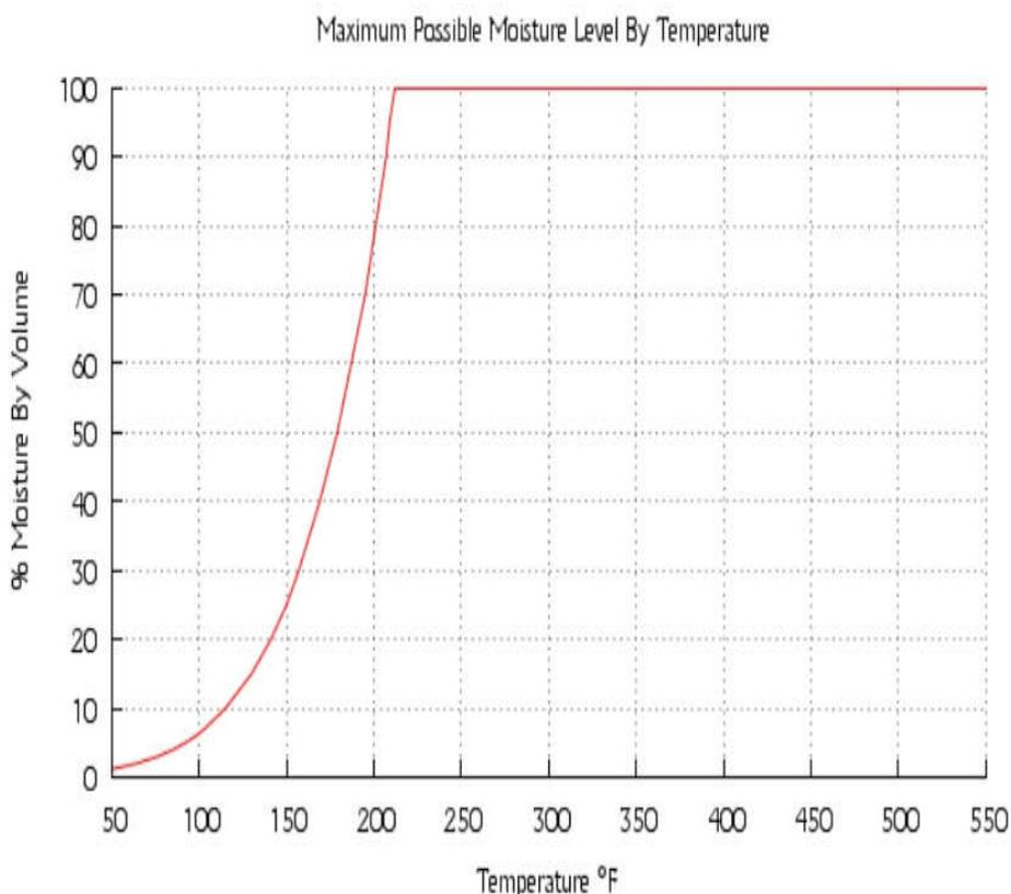
**Slika 2. Prikaz maksimalne vlage na pojedinim temperaturama [6]**
