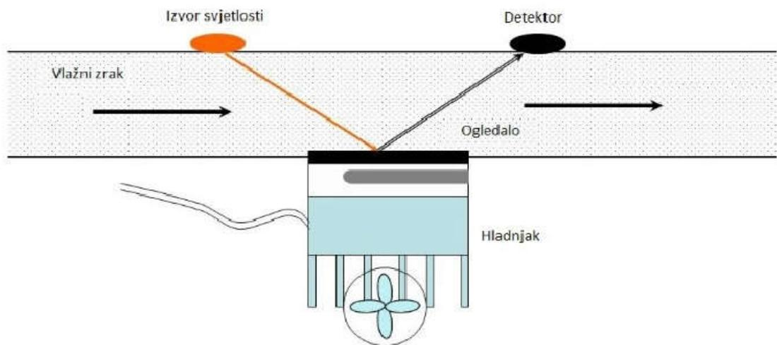
**Slika 4. Princip rada kondenzacijskog higrometra [12].**
