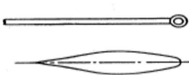
Slika 21. Jednoplošno i strujno kormilo [3]
