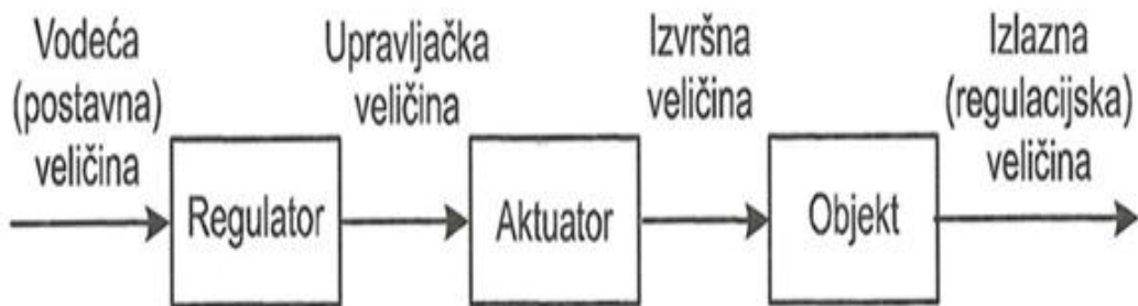
Slika 4. Blok dijagram otvorenog sustava upravljanja [4]
