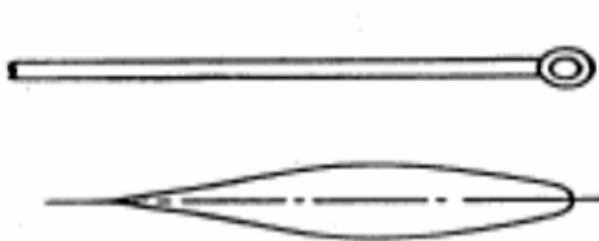
Slika 21. Jednoplošno i strujno kormilo [3]
