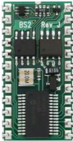
Slika 1. BASIC Stamp 2 mikrokontroler [1]
