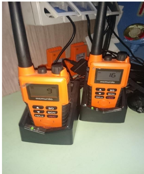
Slika 16. McMurdo R5 prijenosna VHF stanica
