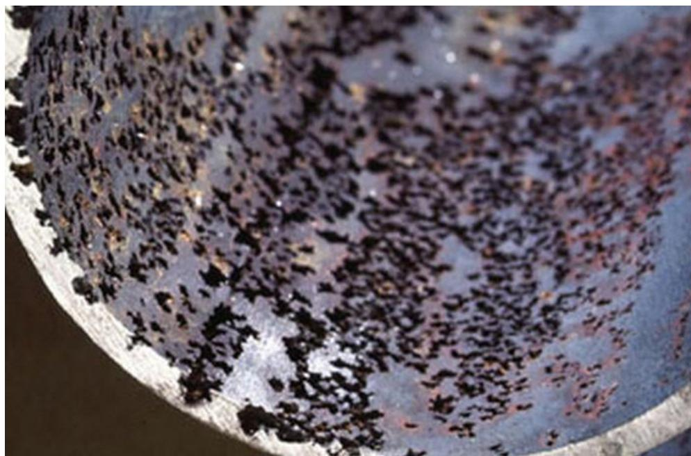
**Slika 15. Točkasta (pitting) korozija u cijevi generatora pare [24]**
