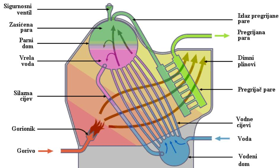
**Slika 10. Shema vodenocijevnog generatora pare [8]**
