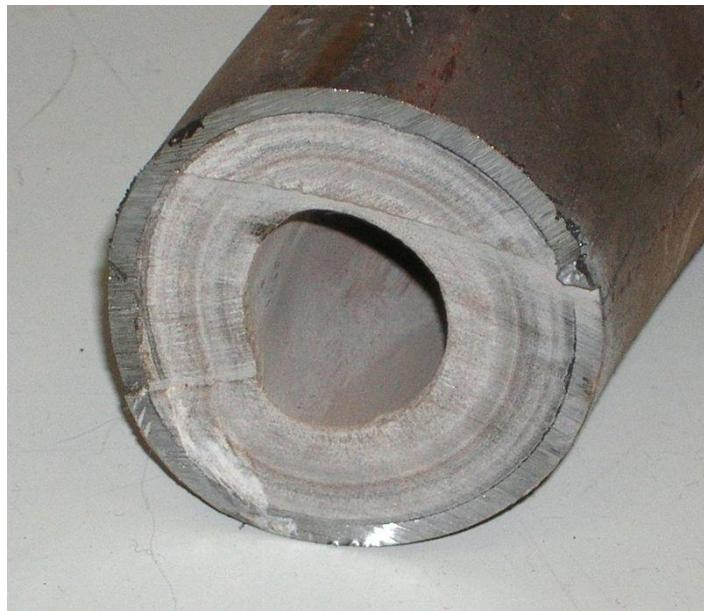
**Slika 13. Talog kamenaca u cijevi generatora pare [15]**
