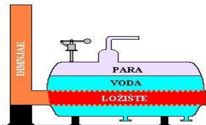
Slika 9. „Cornwall“ cilindrični vatrocijevni generator pare [7]
