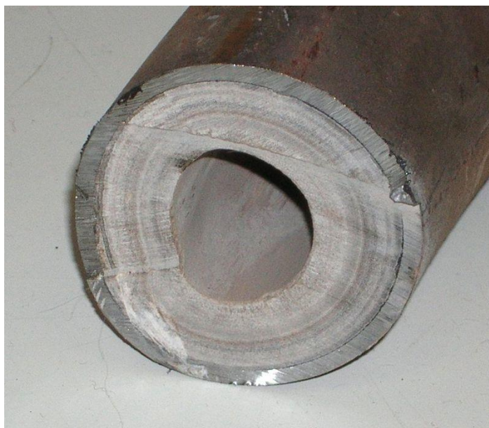
Slika 13. Talog kamenaca u cijevi generatora pare [15]
