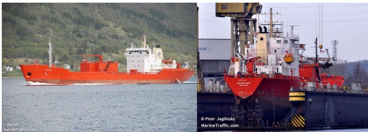
Slika 5. Brod za prijevoz cementa „Cemstar“ [14]
