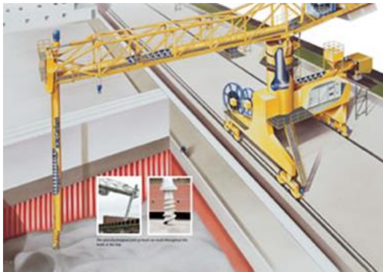
Slika 13. Pneumatski tlačni transporter sa pužnicom [3]
