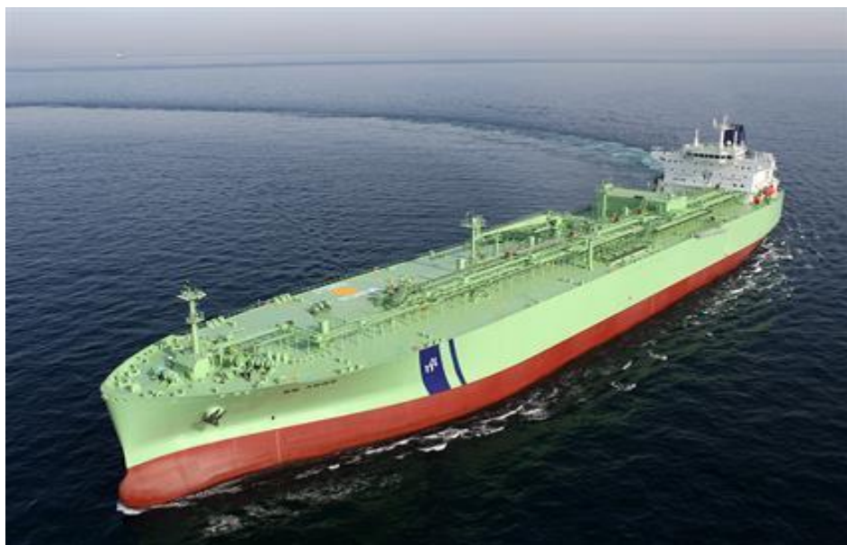
Slika 2. LPG brod za prijevoz polu rashlađenog plina [8]
