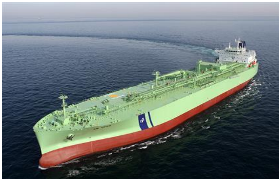
Slika 2. LPG brod za prijevoz polu rashlađenog plina [8]
