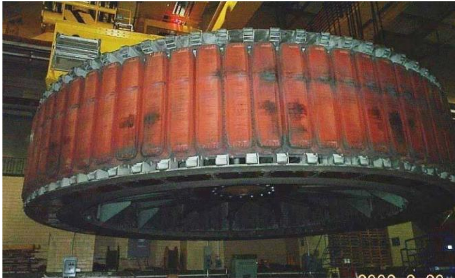
Slika 11. Prikaz rotora hidrogeneratora [13]
