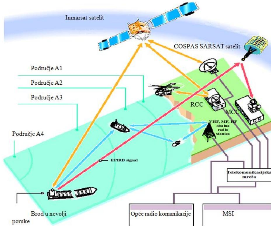
Slika 1. Osnovni koncept rada GMDSS sustava [1]
