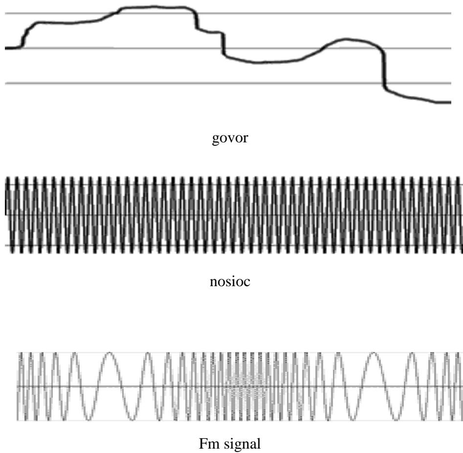
**Slika 19. Primjer frekventne modulacije**
