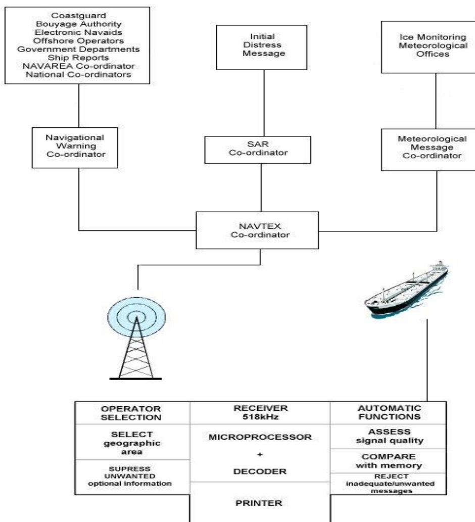
**Slika 10. Princip odašiljanja poruka u Navtex sustavu**
