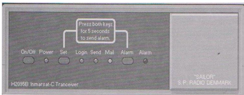
**Slika 18. Primjer pozivanja upomoć pritiskom na jednu tipku**
