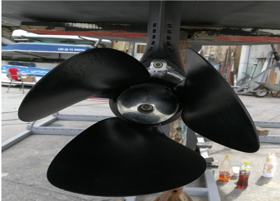
Slika 7. Sklopivi propeler nakon servisa
