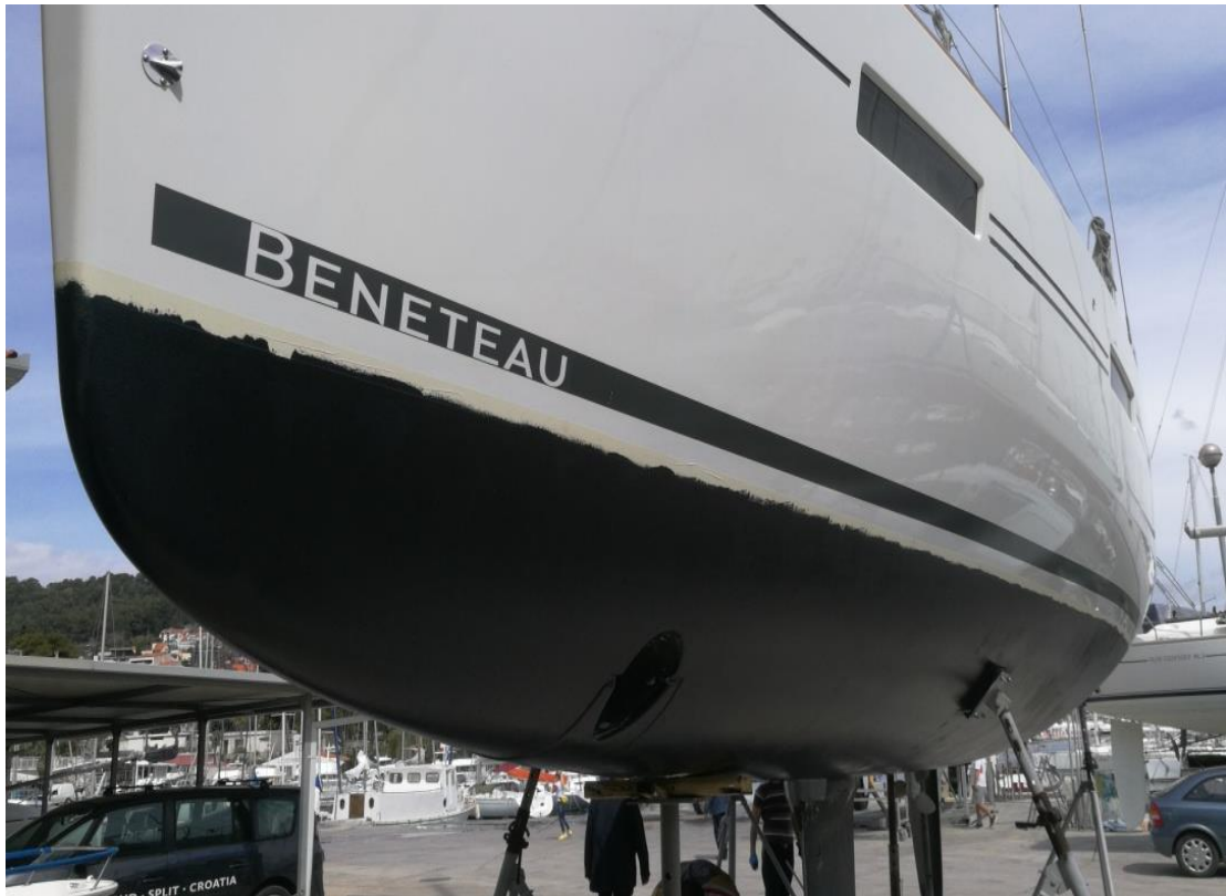
Slika 5. Novi protuobraštajni premaz
