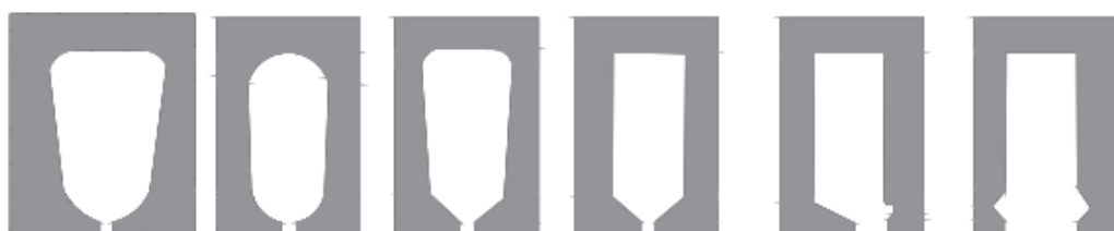
Slika 3. Oblici statorskih utora asinkronog motora [5]
