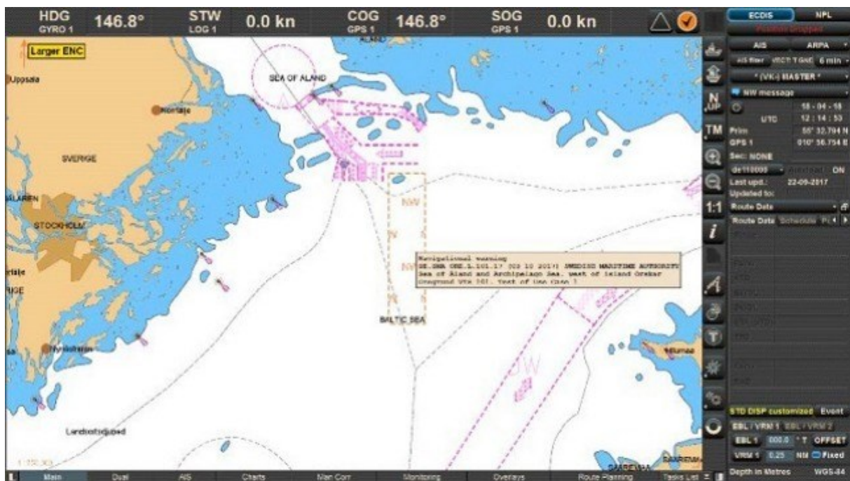
Slika 7. Prikaz zaslona ECDIS-a [13]
