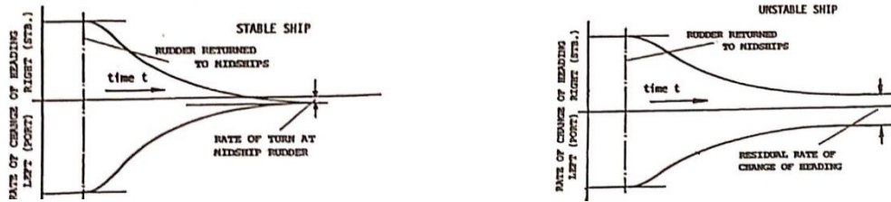
Slika 29. Prikaz rezultata pokusa izvlačenja za stanilan i nestabilan brod
