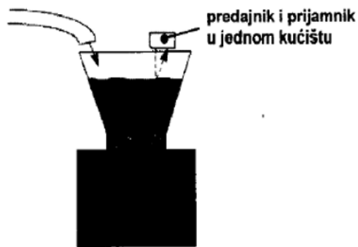
Slika 26. Lasersko mjerenje razine [1]
