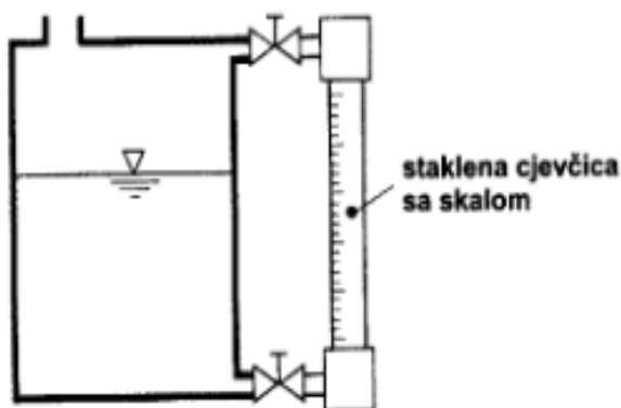
Slika 12. Mjerni uređaj sa staklenom cjevčicom [18]
