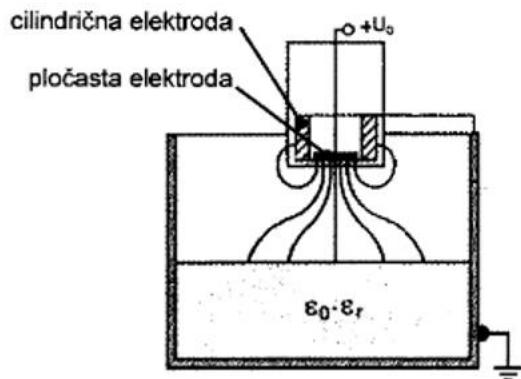
**Slika 22. Mjerni uredaj iznad mjerne tvari [20]**
