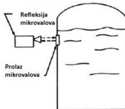
Slika 23. Radarski senzor razine [2]
