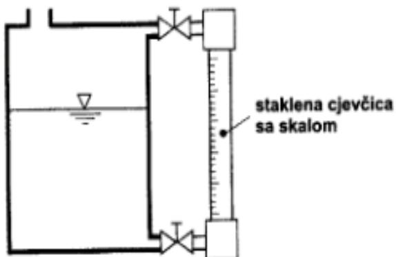
**Slika 12. Mjerni uređaj sa staklenom cjevčicom [18]**
