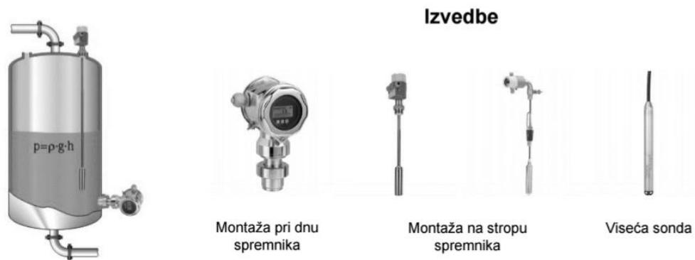
**Slika 17. Mjerenje razine zatvorenog spremnika [1]**
