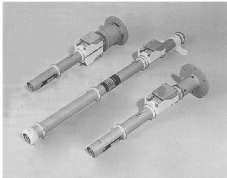
**Slika 30. Kapacitivne sonde za mjerjenje razine goriva u spremniku [20]**
