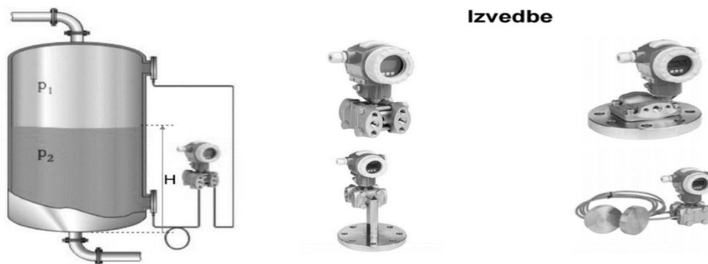
Slika 18. Mjerenje razine otvorenog spremnik [1]
