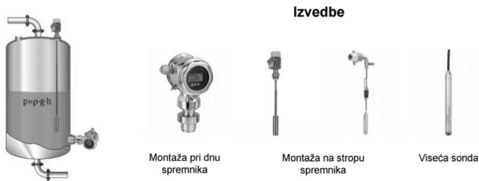
Slika 17. Mjerenje razine zatvorenog spremnika [1]
