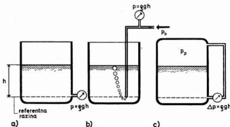
**Slika 15. Mjerjenje hidrostatskog tlaka: a) na referentnoj razini, b) propuhivanjem zraka, c) u zatvorenoj posudi [20]**
