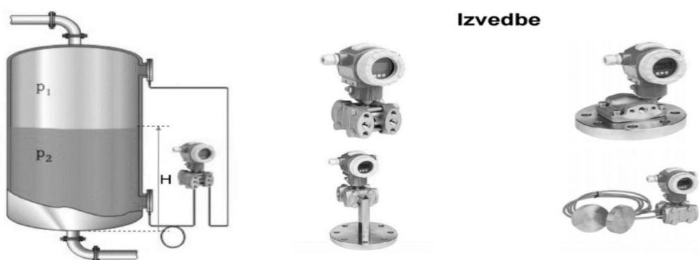
**Slika 18. Mjerenje razine otvorenog spremnik [1]**
