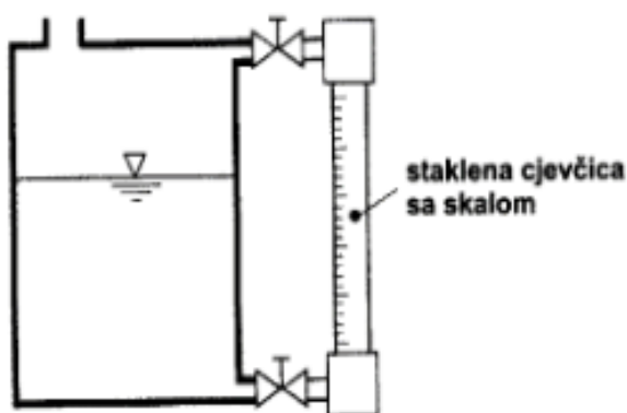
Slika 12. Mjerni uređaj sa staklenom cjevčicom [18]
