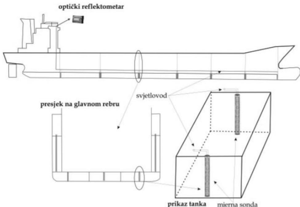
**Slika 28. Smještaj senzora za mjerjenje razine [11]**
