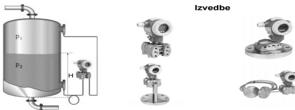
Slika 18. Mjerenje razine otvorenog spremnik [1]
