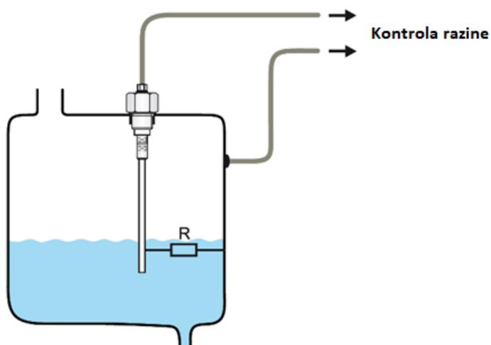
Slika 20. Mjerjenje razine pomoću konduktivnog mjerjenja [3]
