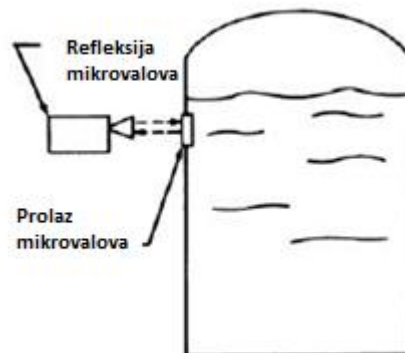
Slika 23. Radarski senzor razine [2]
