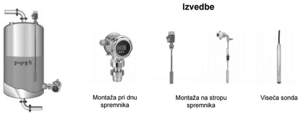
Slika 17. Mjerenje razine zatvorenog spremnika [1]
