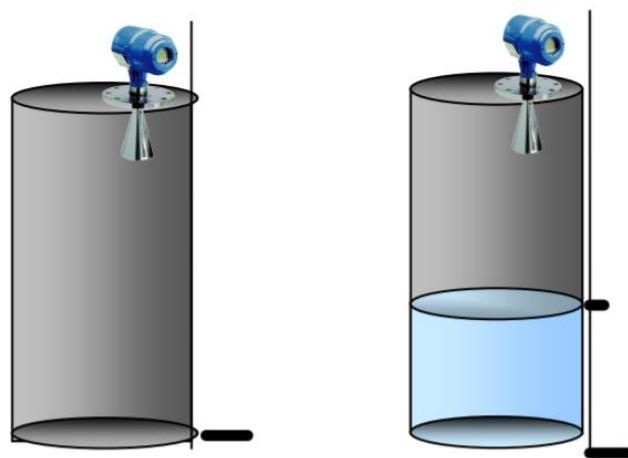
Slika 24. Mjerenje mikrovalnim radarem [19]
