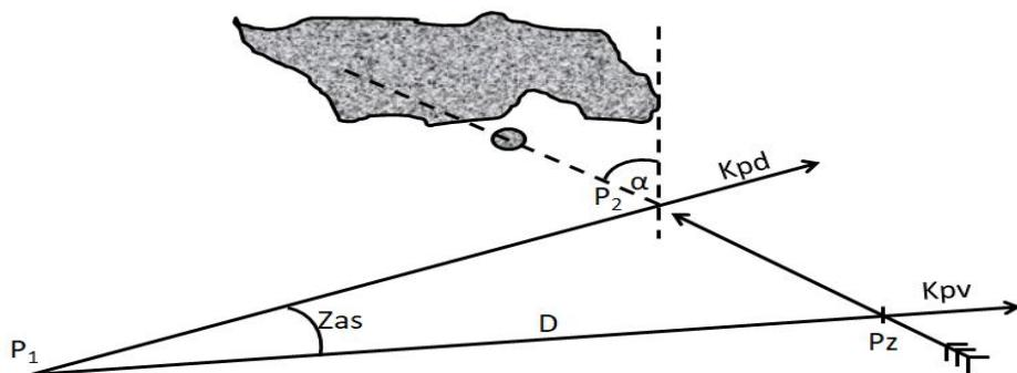
**Slika 4. Određivanje elemenata morske struje na osnovi opažene i zbrojene pozicije**
