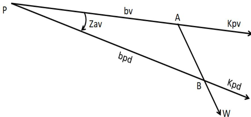
Slika 14. Određivanje zanošenja od vjetra uspoređivanjem brzine broda [1]
