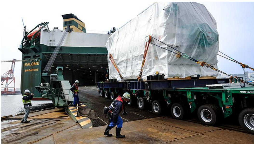
Slika 4. Tehnologija ukrcaja/iskrcaja tereta u RO – RO sustavu [8]
