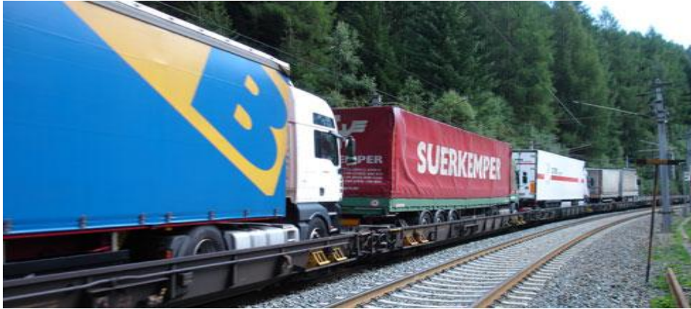
Slika 13. Huckepack A tehnologija transporta [13]
