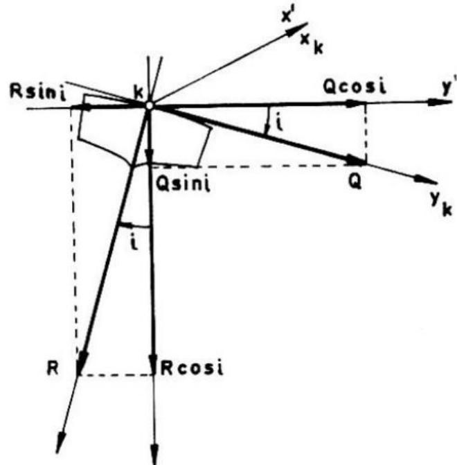
Slika 8. Utjecaj stalnog brodskog magnetizma na devijaciju nagnutoga broda [7]
