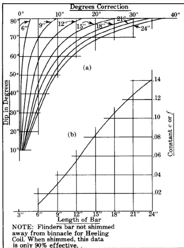
Slika 15: Tablice za određivanje duljine Flindersove motke [4]
