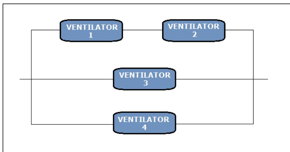
**Slika 30. Preporučena radna konfiguracija ventilatora (konf. A)**
