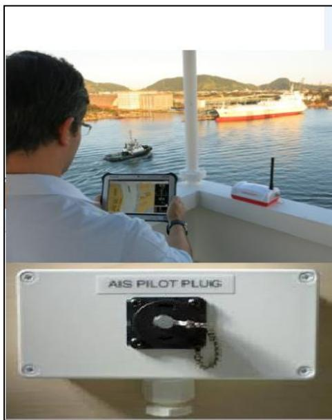
**Slika 31. Prijenosna pilotska jedinica [40]**
