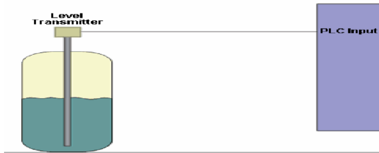
Slika 2.4. Primjer analognog ulaza [2]
